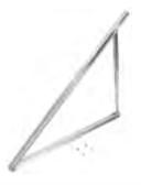
Дополнительная опора FKF 8-2                | <ul style="list-style-type: none"> <li>Для крепления лотков FKF 7-2 устанавливается на 3, 5, 7 и 9 коллектор в ряду</li> <li>При снеговой нагрузке от 2,0 до 3,8 кН/м<sup>2</sup> устанавливается на каждый дополнительный (2-10) коллектор в ряду</li> </ul>                                   | 8718531036 | По запросу |               |
