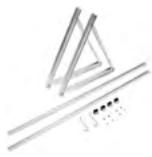
Основной монтажный комплект FKF 5-2         | <ul style="list-style-type: none"> <li>Для установки на плоской крыше или фасаде первого коллектора (1x на каждый ряд коллекторов)</li> <li>Для скорости ветра до 151 км/ч (напор 1,1 кН/м<sup>2</sup>) и снеговой нагрузки до 3,8 кН/м<sup>2</sup></li> </ul>                                  | 8718531033 | По запросу | 01            |
