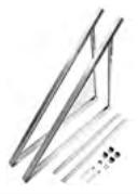
Основной монтажный комплект FKF 3-2           | <ul style="list-style-type: none"> <li>Для установки на плоской крыше первого коллектора (1x на каждый ряд коллекторов)</li> <li>Для скорости ветра до 151 км/ч (напор 1,1 кН/м<sup>2</sup>) и снеговой нагрузки до 2,0 кН/м<sup>2</sup></li> </ul>                                             | 8718531031 | 440,00     |               |
