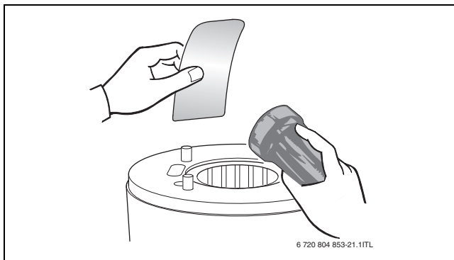
Мал. 52 Перевірка котлового блоку, який включає камеру згорання і теплообмінник, на наявність відкладень
