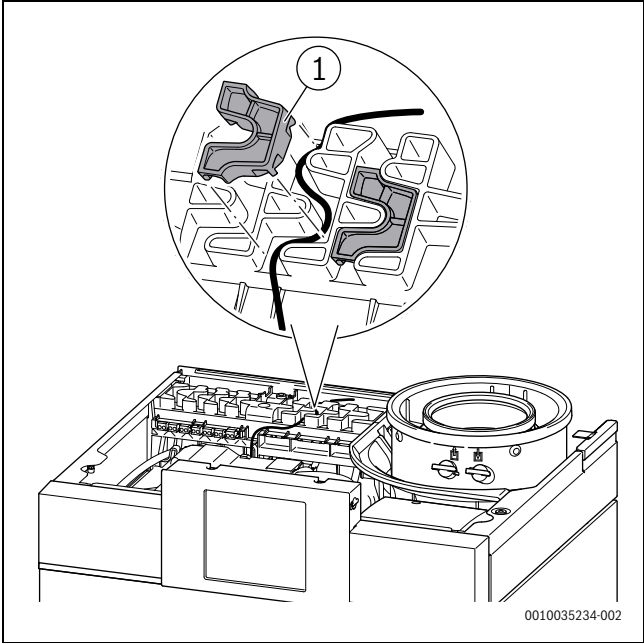
Мал. 24 Розташування з'єднувального кабелю та кабельного каналу
