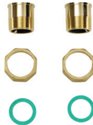
Рис. 103 Комплект підключення розподільного блоку AS HKV... AS HKV 25: приєднувальна різьба R 1" для DN25 AS HKV 32: приєднувальна різьба R 1 1/4" для DN32
