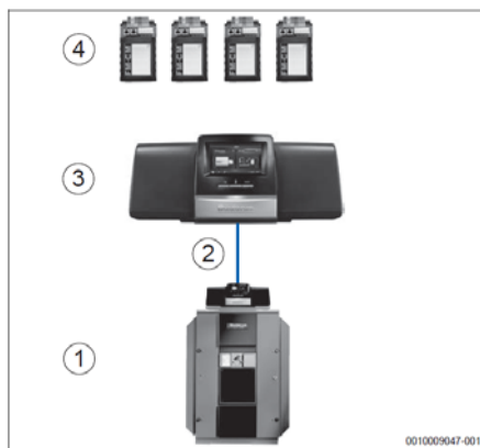
Рис. 36 Система керування Logamatic 5311 для опалювальних котлів з навісним вентиляторним пальником
