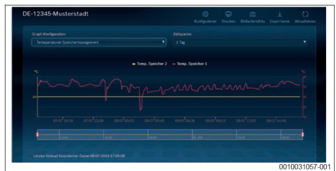
Рис. 100 Control Center Commercial PLUS: граф; індикація збережених точок даних. Макс. тривалість збереження: 2 роки, роздільна здатність: кроки по 1°: максимум до 125 точок даних
