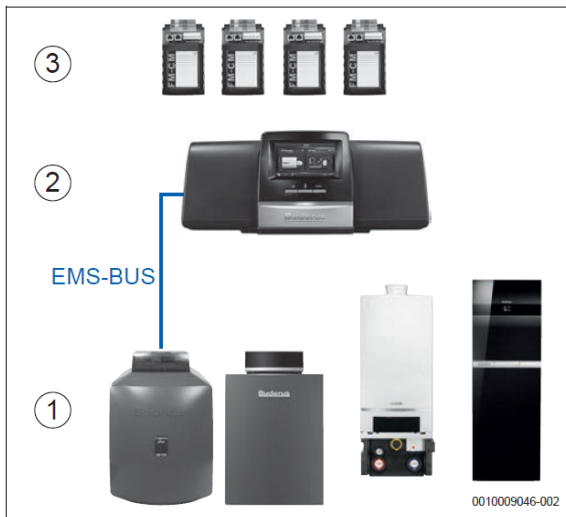
Рис. 23 Настінне встановлення: Система керування Logamatic 5313 для опалювальних котлів або настінних (навісних) опалювальних котлів в діапазоні від малої до середньої потужності, власний регулятор роботи котла, підключення до Logamatic 5000 через шину EMS-BUS (наприклад, Logano plus GB125, Logano plus GB212, Logatex plus GB162, Logatex plus GB192i)
