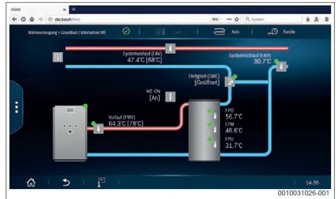
Рис. 58 Приклад відображення альтернативного теплогенератора в Logamatic 5000 (залежно від прив'язки альтернативного теплогенератора ідентифікаційні схеми на рівні користувача представлені в розширеному вигляді)
