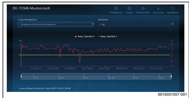
Рис. 48 Control Center CommercialPLUS: Graph; індикація записаних точок даних. Оновлення кожні 6 годин автоматично або вручну одразу. Макс. тривалість зберігання: 2 роки, роздільна здатність: крок 0,5°; макс. до 125 точок даних
