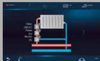
Monitoring / manuálne ovládanie vykurovacieho okruhu
