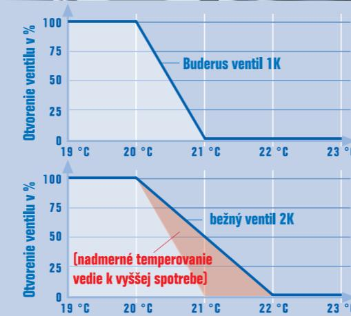
Ventily 1K Buderus zatvárajú v spoluprácu s termostatickými hlavicami už vtedy, ak je priestorová teplota iba 1 °C nad požadovanou teplotou. Spodný diagram ukazuje, že bežné termostatické ventily 2K sú v tomto čase ešte na 50% otvorené, zatvárajú až pri priestorovej teplote zvýšenej o 2°C a mrhajú energiou.
