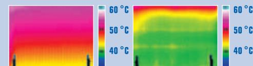
Ako rovnomerne odovzdáva teplo čelo vedúce vodu ukazuje ľavý tepelný obraz. V protiklade k tomu je vpravo bežné ploché vykurovacie teleso s nalepeným čelom. Čelo vedúce vodu má jednoznačne strednú povrchovú teplotu. Preto sú výkon a podiel sámania vyššie. To má za následok cítelne Plus v pohodli.
