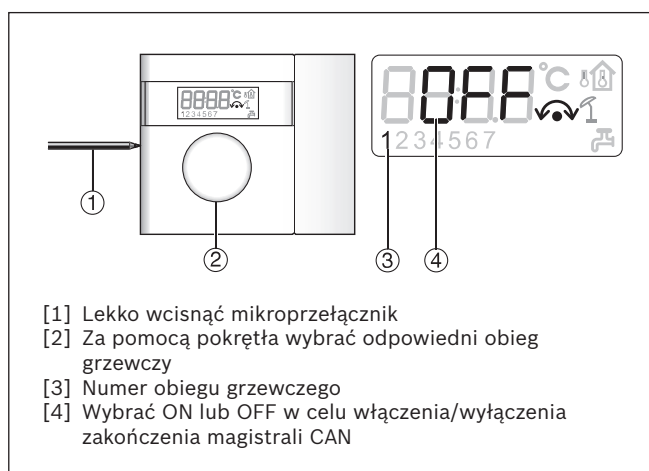
Rys. 29 Adresowanie regulatora strefowego HRC2
