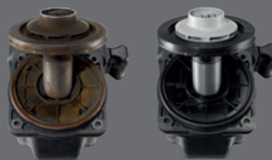
Osady magnetytu i szlamu na pompie obiegowej.
