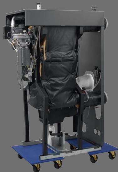
La nouvelle construction pratique en X du châssis facilite l'accessibilité et le montage aux installateurs. Dans son conditionnement à la livraison, la chaudière à condensation peut être posée sur des planches à roulettes traditionnelles et poussée jusqu'au lieu d'installation. De nombreux composants, tel que le brûleur et les rails de fixation pour le carénage de la chaudière, se démontent rapidement pour le transport.
