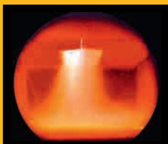
*L'immagine tecnica illustra la forza con cui la miscela d'aria e gas turbinata nella camera di combustione a zone di incandescenza. Questo movimento costante contribuisce in modo determinante ad una combustione povera di residui.*
