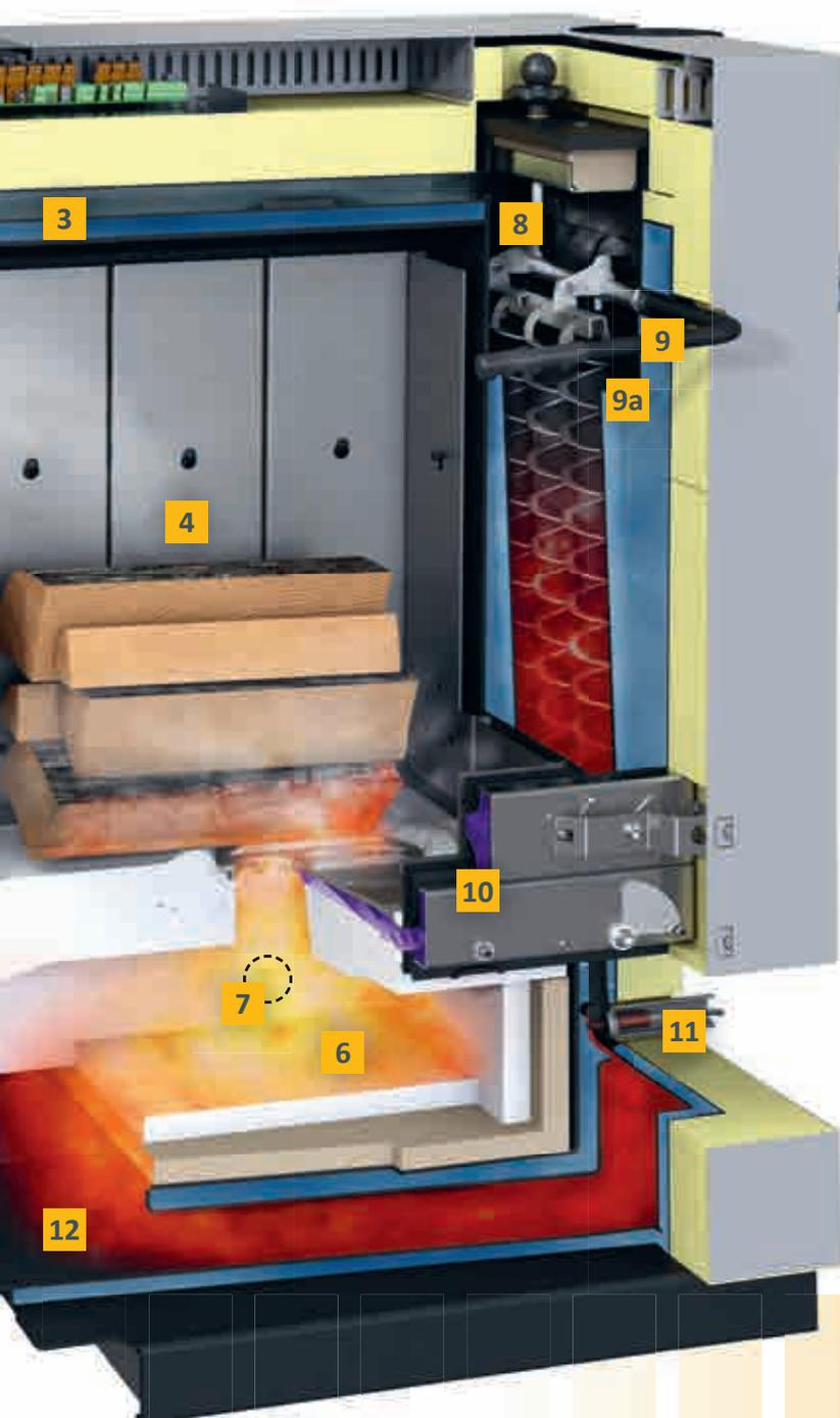
**8 Aspiratore:** questo ventilatore assicura la depressione della caldaia, garantendo la massima silenziosità. Inoltre regola la quantità d'aria al suo interno garantendo così la sicurezza nel locale caldaia.
