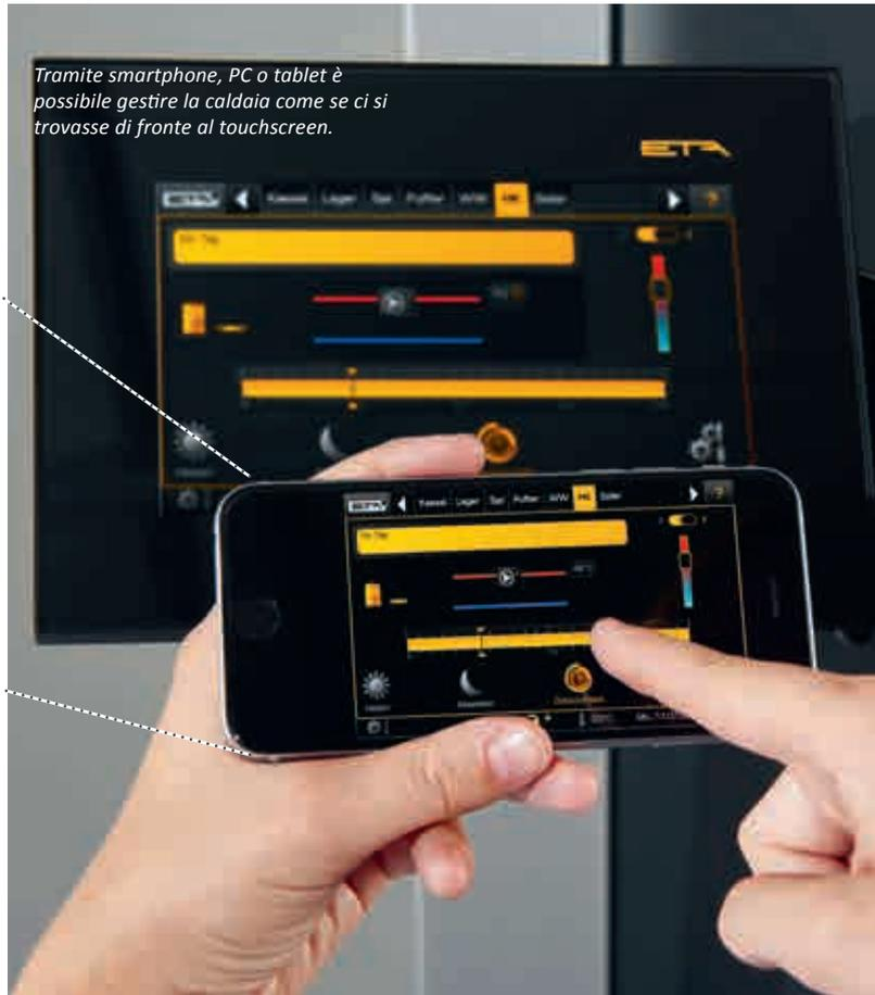
tablet o dal PC. In questo modo è possibile avere il riscaldamento sotto controllo, dovunque vi troviate. Effettuando il login all'indirizzo [www.meinETA.at](http://www.meinETA.at), si potrà vedere il touchscreen esattamente come se ci si trovasse davanti alla caldaia!
