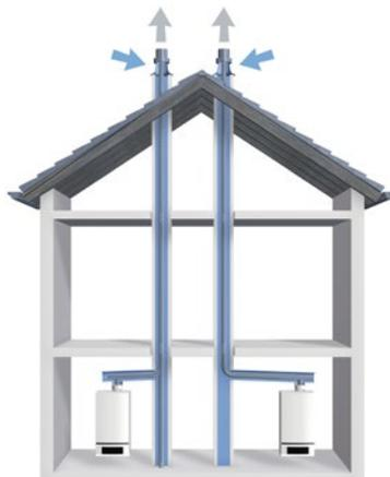
Exemple de construction ancienne ou neuve, où une cheminée ou un conduit existant est adapté à l'aspiration d'air. À gauche, indépendante de l'air ambiant avec le tube d'évacuation tiré dans la cheminée, à droite avec conduit d'évacuation existant dans la cheminée (configuration simple).
