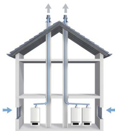
Exemple de bâtiment ancien, dans lequel une cheminée ou un conduit ne convient pas pour l'aspiration d'air. Branchement simple dépendant de l'air de la pièce (à gauche) ou en cascade (à droite).
