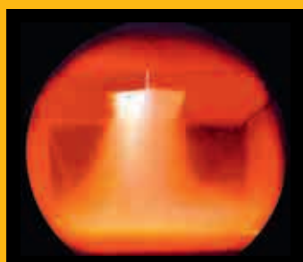
Le mélange d'air et de gaz tourbillonne dans le foyer à zones d'incandescence isolées. Ce mouvement permanent contribue à la combustion quasiment sans résidus du combustible.
