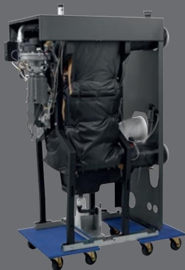
Durante il trasporto, l'introduzione e il montaggio i professionisti possono avvantaggiarsi della nuova pratica costruzione del telaio a forma di X. La caldaia a condensazione, nell'esecuzione per la consegna, può essere posata su comuni basi con rotelle per lo spostamento di mobili e così spinta fino al locale di posa. Molti componenti come per esempio il bruciatore e le traverse di fissaggio per il rivestimento della caldaia possono essere smontate rapidamente per essere trasportate.
