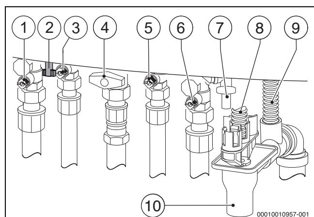
Рис. 29 Подключения газа и воды (дополнительное оборудование)
