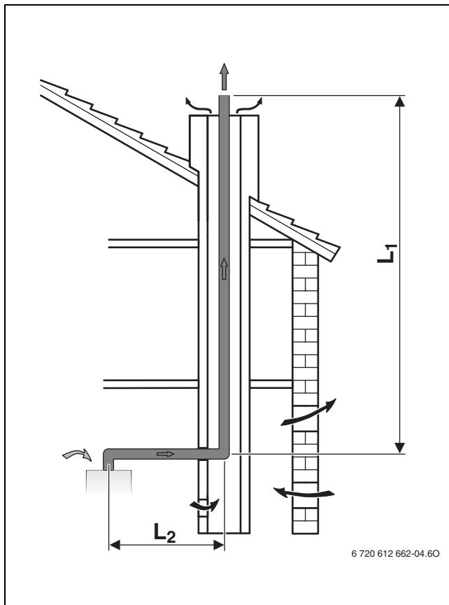
Рис. 8 Дымовая труба в шахте по B<sub>23</sub>
