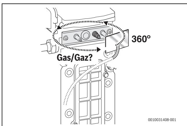
Рис. 58 Проверка герметичности
