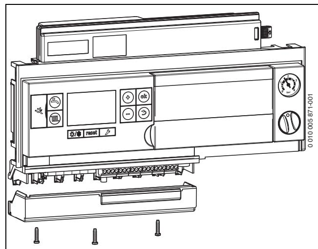
Рис. 76 Снимите крышку
