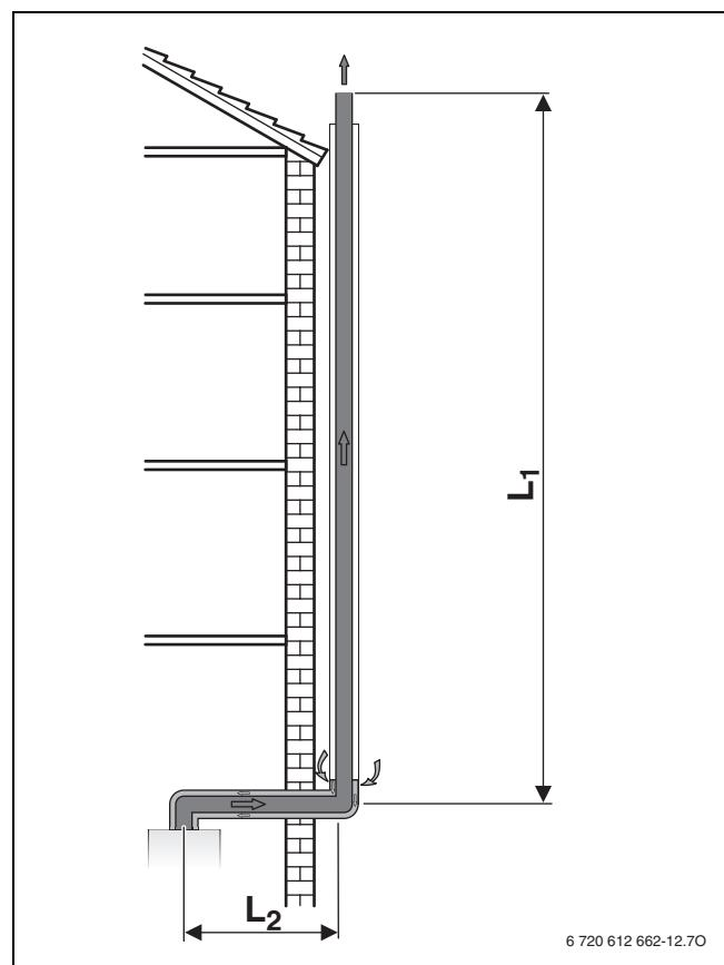
Рис. 17 Дымовая труба на фасаде по С<sub>53</sub>
