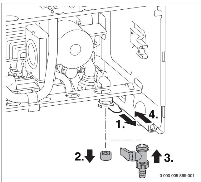
Рис. 27 Установка крана для заполнения и слива
