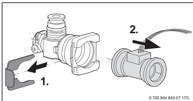
Рис. 56 Демонтаж турбины на труbe холoдной воды
