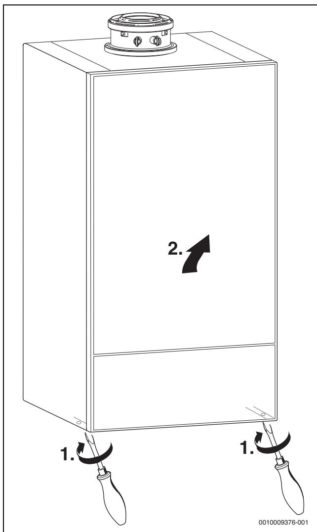
Рис. 24 Снятие облицовки
