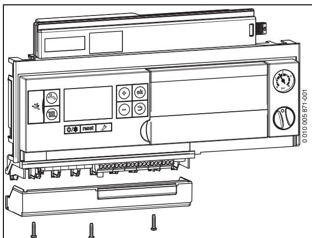
Рис. 32 Снятие крышки
