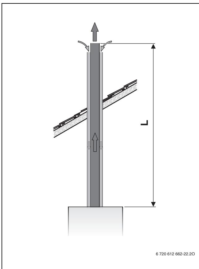
Рис. 15 Вертикальный отвод дымовых газов по С<sub>33</sub>
