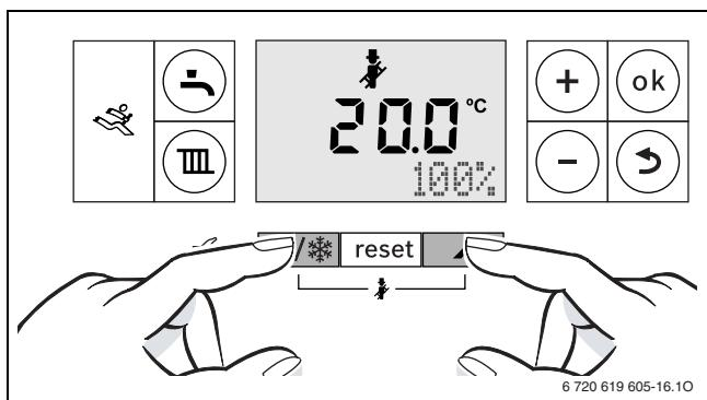
Рис. 52 100 % (максимальная номинальная теплопроизводительность ГВС)
