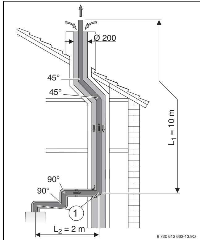
Рис. 18 Монтажная ситуация с отводом дымовых газов по С<sub>93</sub>
