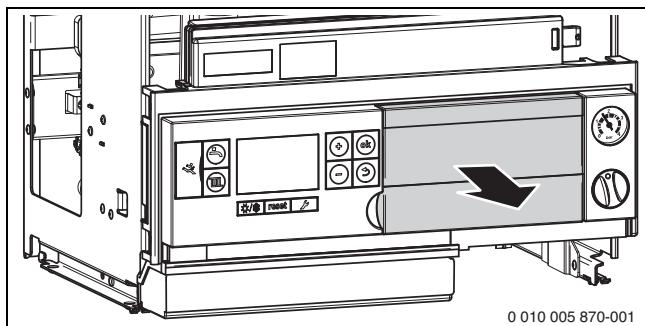
Рис. 31 Удаление крышки и установка пульта управления
