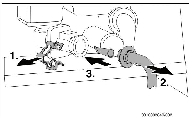
Рис. 55 Выньте сетчатый фильтр из трубы холодной воды
