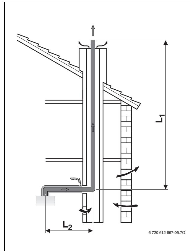
Рис. 9 Дымовая труба в шахте по B<sub>33</sub>
