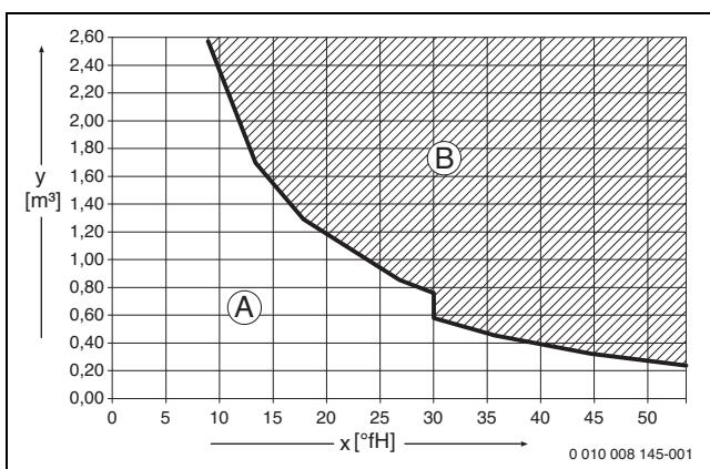
Рис. 21 Требования к воде для заполнения и подпитки в  $^{\circ}\text{H}$  для котлов  $< 50 \text{ кВт}$
