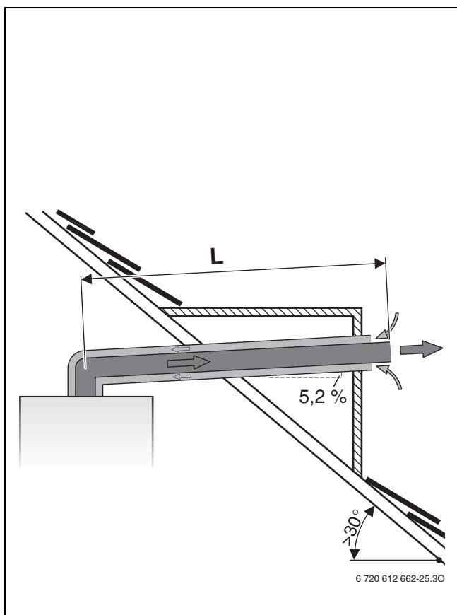
Рис. 13 Горизонтальный отвод дымовых газов по С13
