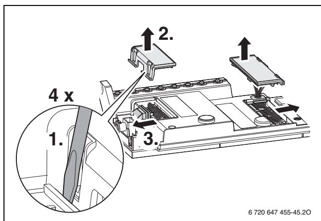
Рис. 78 Снимите крышку
