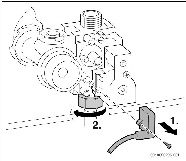
Рис. 74 Выньте штекер и отверните накидную гайку
