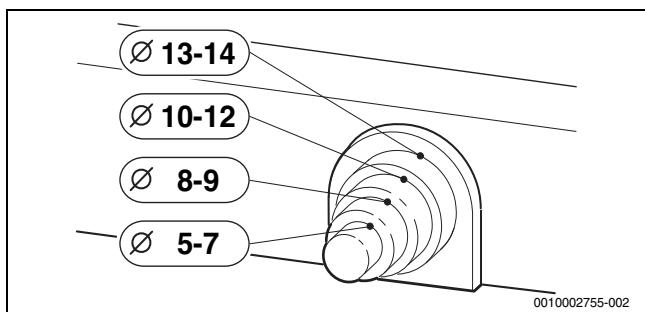
Рис. 33 Обрежьте фиксатор в соответствии с диаметром кабеля
