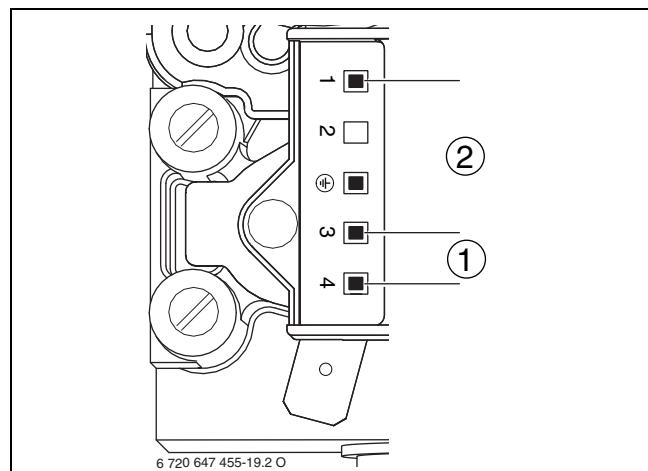
Рис. 72 Точки измерений на газовой арматуре
