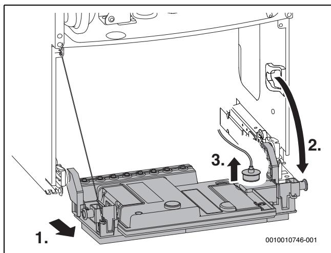
Рис. 77 Откинте блок управления вниз
