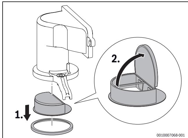
Рис. 68 Обратный клапан в смесительном устройстве
