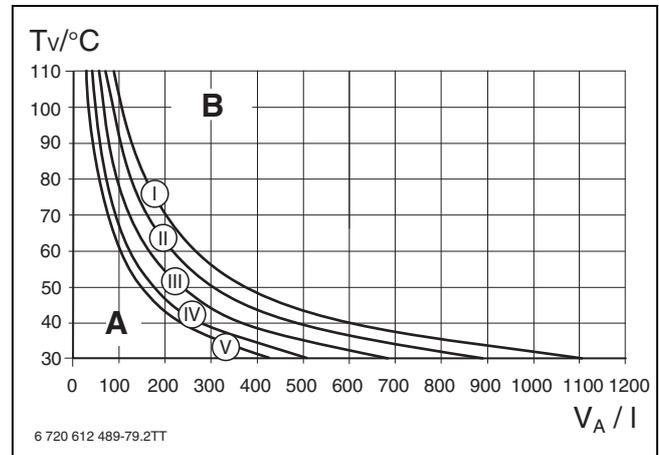
Σχ. 24 Χαρακτηριστικές καμπύλες του δοχείου διαστολής
