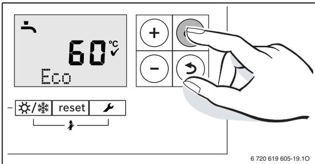
Σχ. 42 Επιβεβαίωση ένδειξης λειτουργίας eco
