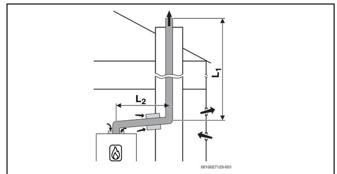
Σχ. 18 Άκαμπος αγωγός καυσαερίων κατά B<sub>23p</sub>/B<sub>53p</sub> με παροχή αέρα από τον χώρο εγκατάστασης στη συσκευή και ομόκεντρο στοιχείο σύνδεσης ανάμεσα στον χώρο τοποθέτησης και το φρεάτιο
