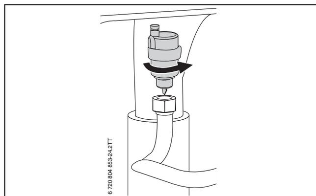
Σχ. 70 Αφαίρεση αυτόματου εξαεριστήρα
