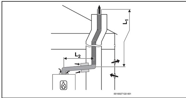
Σχ. 19 Εύκαμπτος αγωγός καυσαερίων στο φρεάτιο κατά  $B_{23p}/B_{53p}$  με παροχή αέρα από τον χώρο εγκατάστασης στη συσκευή και ομόκεντρο στοιχείο σύνδεσης ανάμεσα στον χώρο τοποθέτησης και το φρεάτιο
