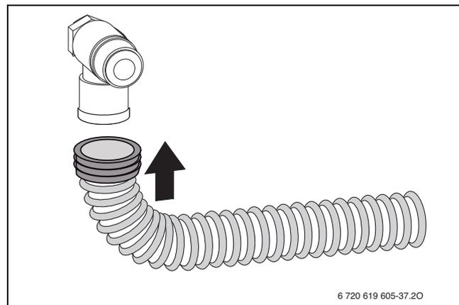
Σχ. 26 Συναρμολόγηση εύκαμπτου σωλήνα της βαλβίδας ασφαλείας
