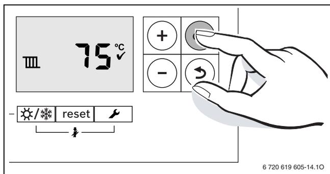
Σχ. 38 Επιβεβαίωση ένδειξης λειτουργίας θέρμανσης
