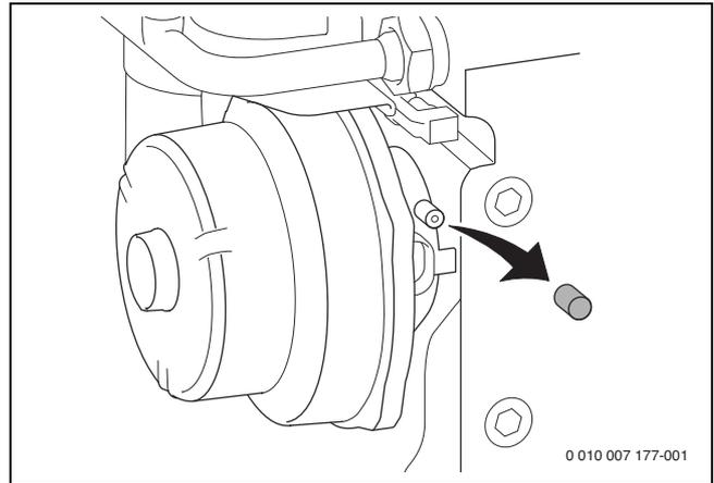
Σχ. 62 Στόμιο μέτρησης στη διάταξη ανάμειξης
