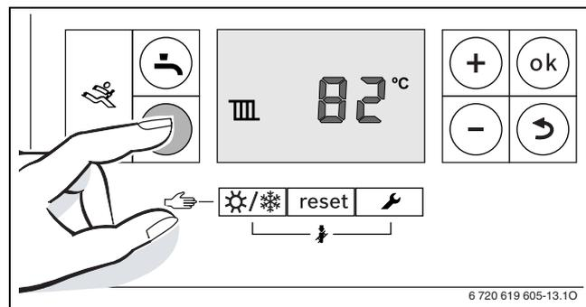
Σχ. 39 Ένδειξη θερμοκρασίας προσαγωγής
