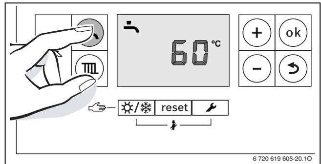
Σχ. 43 Ένδειξη θερμοκρασίας ζεστού νερού
