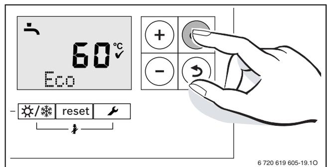
Σχ. 44 Επιβεβαίωση ένδειξης θερμοκρασίας ζεστού νερού
