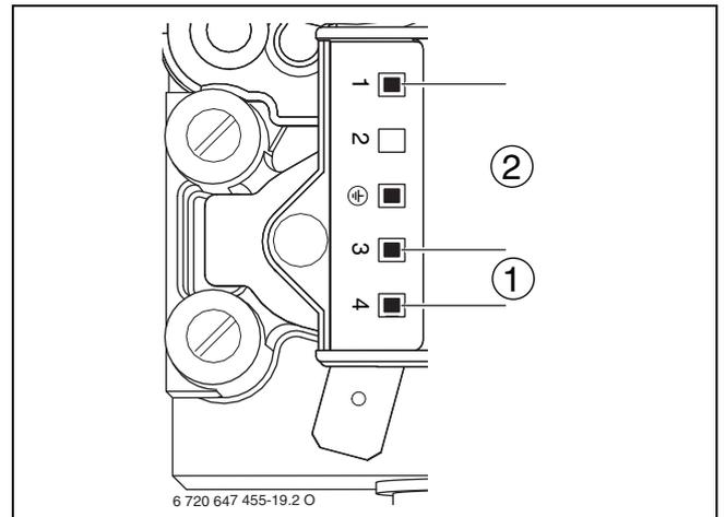
Σχ. 73 Σημεία μέτρησης στη βάνα αερίου
