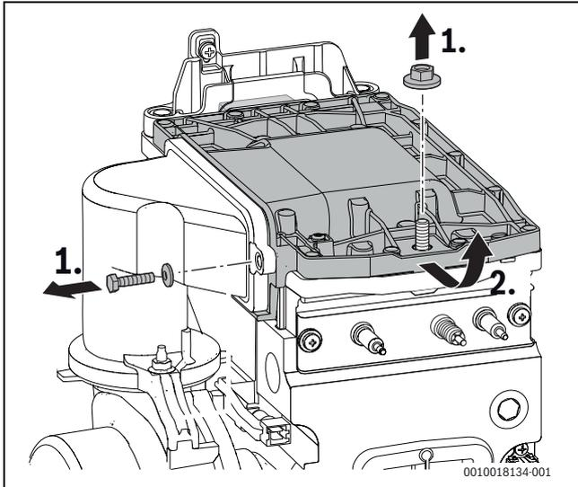
Σχ. 60 Χαλάρωση καπακιού καυστήρα
