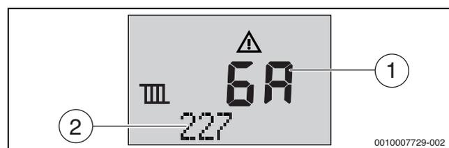
Σχ. 82 Παράδειγμα: Ένδειξη μιας βλάβης που κλειδώνει
