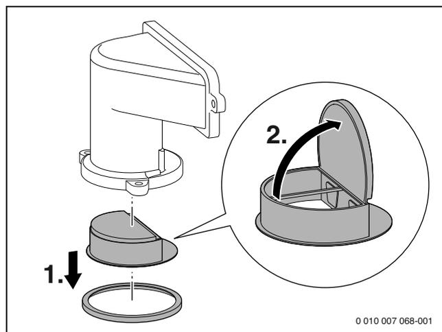
Σχ. 69 Βαλβίδα αντεπιστροφής στη διάταξη ανάμειξης
