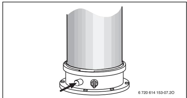
Σχ. 50 Στόμιο μέτρησης καυσαερίων
