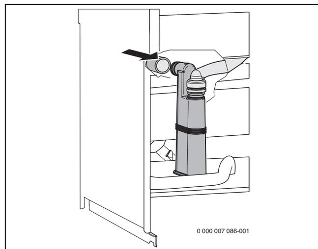
Σχ. 27 Συναρμολόγηση εύκαμπτου σωλήνα στο σιφόνι συμπικνώματος
