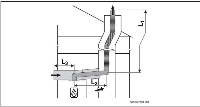
Σχ. 13 Εύκαμπτος αγωγός καυσαερίων κατά C<sub>53x</sub> στο φρεάτιο και αγωγός αέρα-καυσαερίων με ξεχωριστή παροχή αέρα και ομόκεντρη απαγωγή καυσαερίων στον χώρο τοποθέτησης
