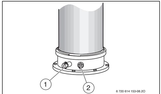
Σχ. 54 Στόμιο μέτρησης καυσαερίων και στόμιο μέτρησης αέρα καύσης
