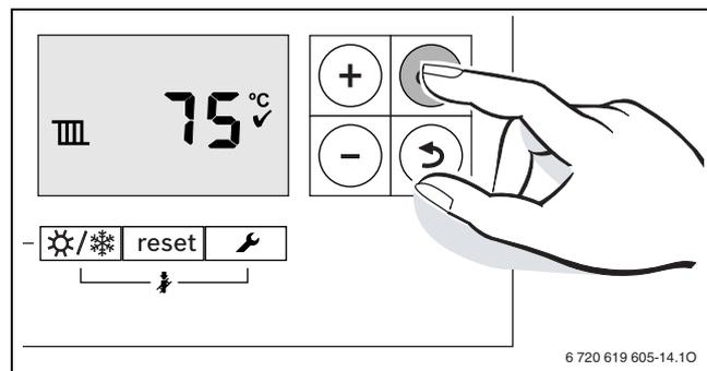
Σχ. 40 Επιβεβαίωση ένδειξης θερμοκρασίας προσαγωγής
