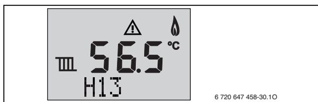
Σχ. 81 Παράδειγμα: Βλάβη που δεν οδηγεί σε μπλοκάρισμα
