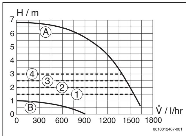
Σχ. 85 Χαρακτηριστικά διαγράμματα και χαρακτηριστικές καμπύλες κυκλοφορητή
