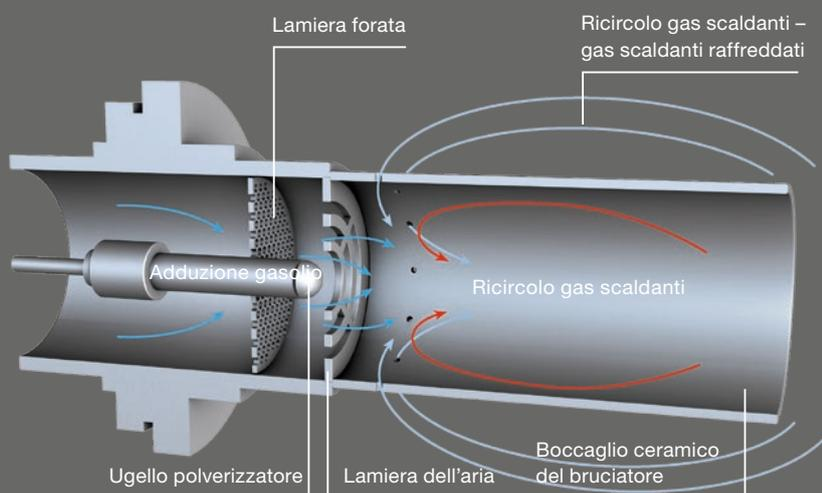
Grazie alla sua raffinata tecnologia il bruciatore a fiamma blu Logatop BE1 assicura una combustione particolarmente efficiente ed esente da fuliggine. La depressione all'ugello di uscita del gasolio aspira all'indietro i gas scaldanti. In questo modo le goccioline di gasolio evaporano prima di bruciare.
