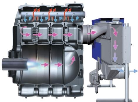
Lo scambiatore di calore a condensazione della Logano plus GB225 ricava calore aggiuntivo dalla condensazione dei gas di scarico della combustione. Così l'energia del combustibile impiegato viene sfruttata in modo ottimale.
