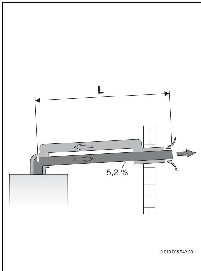
Рис. 13 Горизонтальный отвод дымовых газов по С<sub>13</sub>
