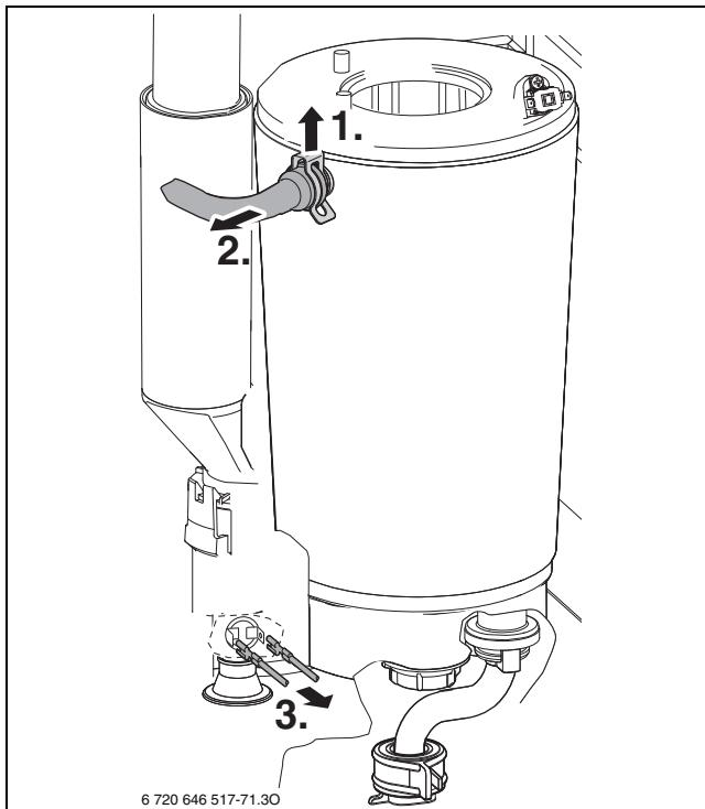
Рис. 79 Отсоедините трубу подающей линии и провода
