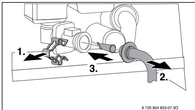
Рис. 67 Выньте сетчатый фильтр из трубы холодной воды
