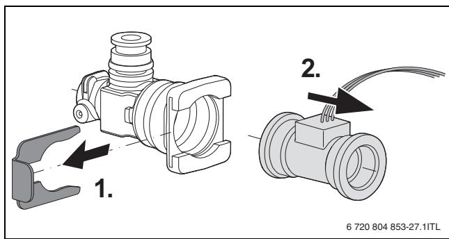
Рис. 68 Демонтаж турбины на трубе холодной воды
