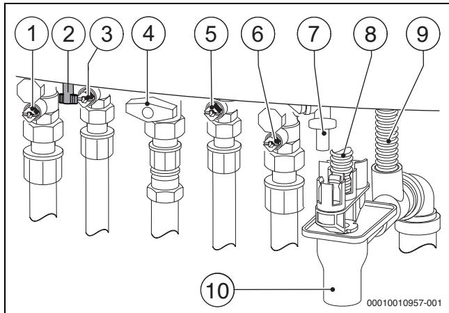
Рис. 28 Подключения газа и воды (дополнительное оборудование)
