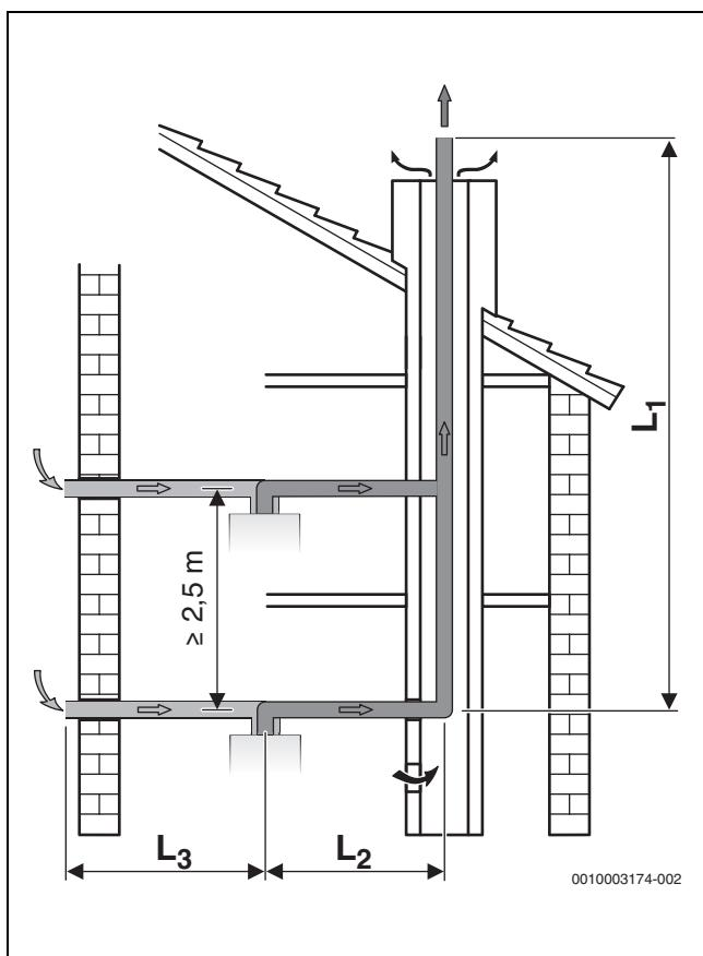
Рис. 19 Подключение нескольких котлов с раздельными трубами по С83
