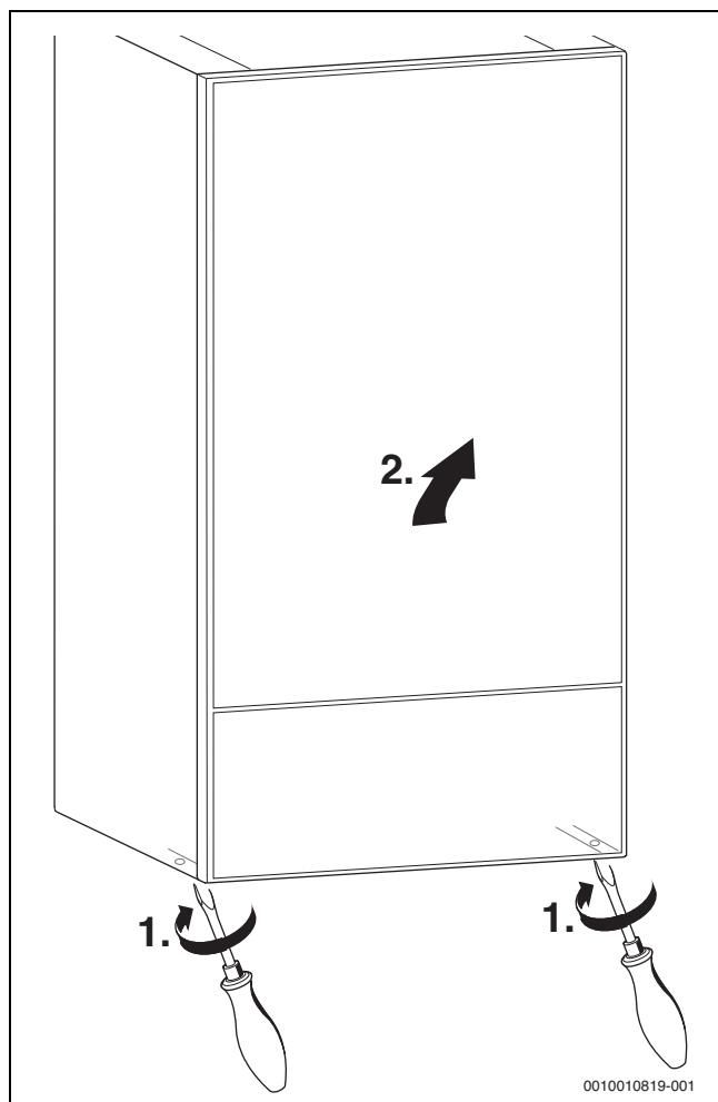
Рис. 23 Снятие облицовки
