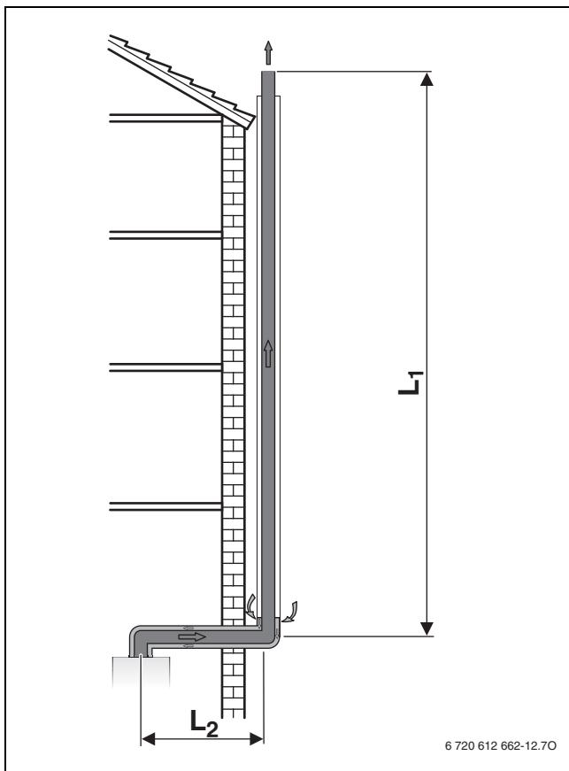
Рис. 16 Дымовая труба на фасаде по С<sub>53</sub>**Анализ монтажной ситуации**
