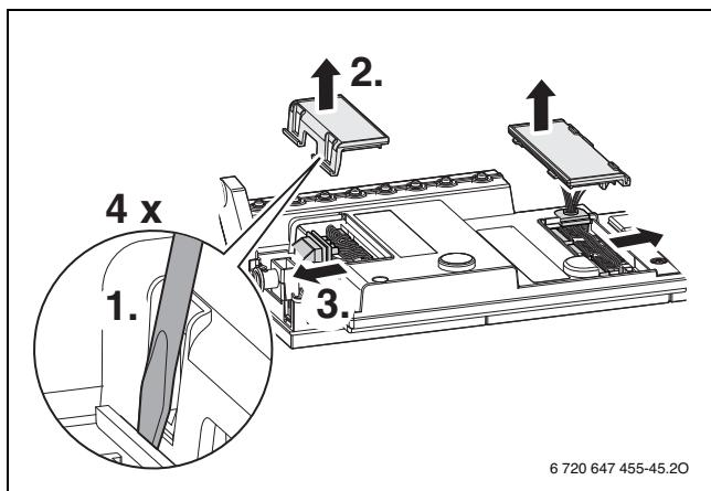
Рис. 77 Снимите крышку
