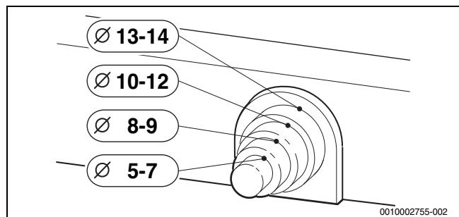
Рис. 32 Обрежьте фиксатор в соответствии с диаметром кабеля
