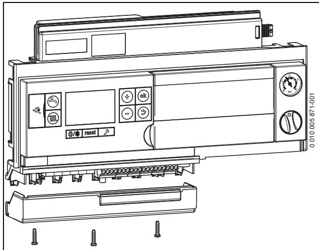
Рис. 75 Снимите крышку
