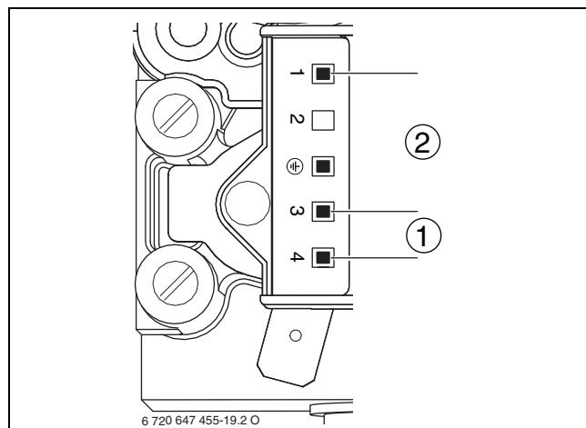
Рис. 72 Точки измерений на газовой арматуре
