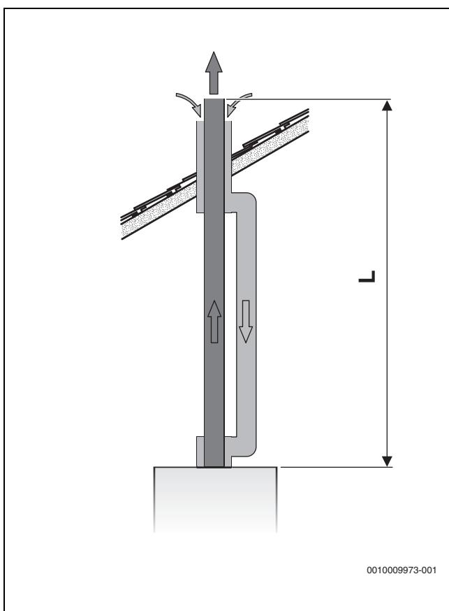
Рис. 15 Вертикальный отвод дымовых газов по С<sub>33</sub>
