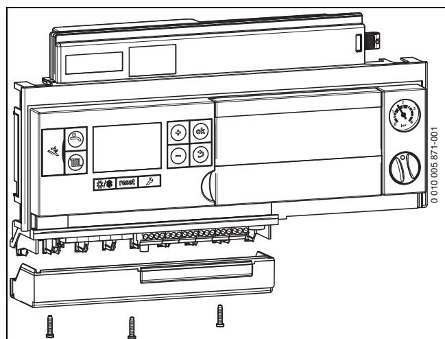
Рис. 31 Снятие крышки
