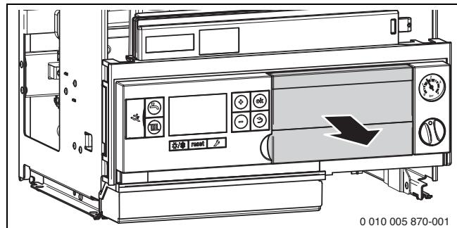
Рис. 30 Удаление крышки и установка пульта управления
