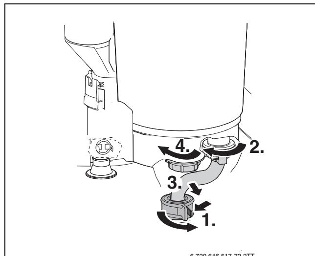
Рис. 80 Отверните гайку и отсоедините трубу обратной линии
