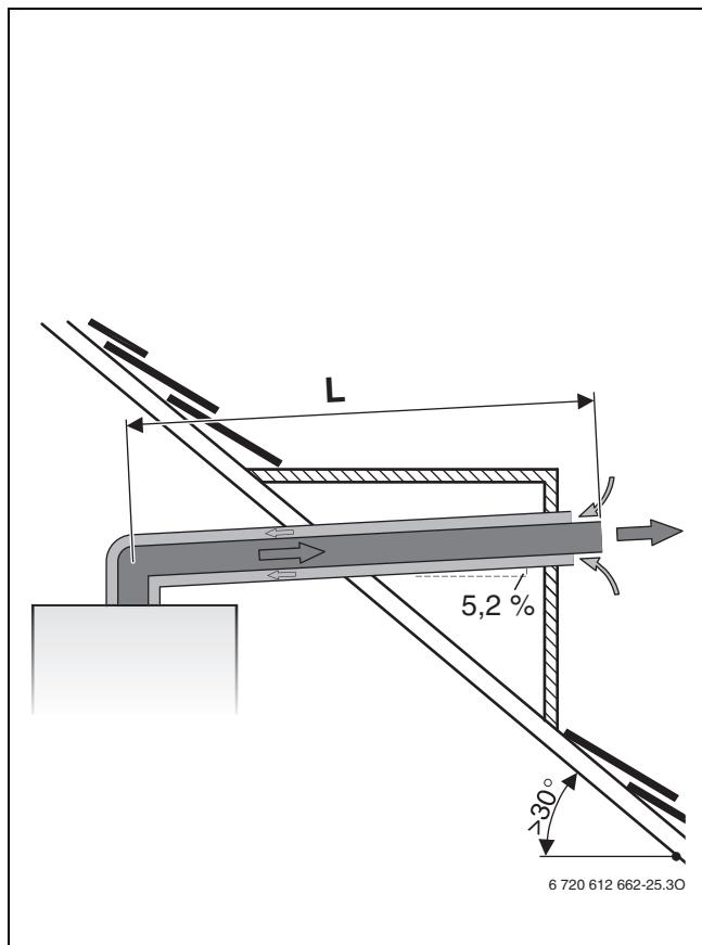
Рис. 12 Горизонтальный отвод дымовых газов по С<sub>13</sub>
