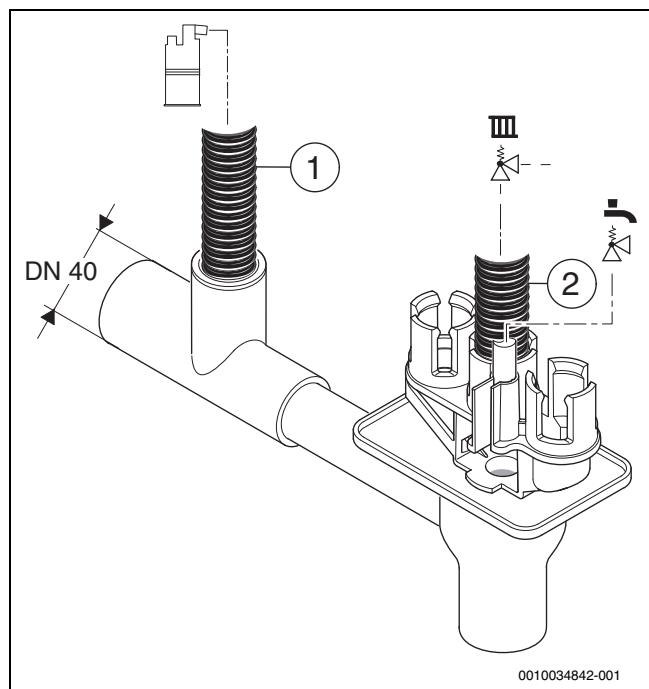
Рис. 27 Смонтируйте шланг слива конденсата и шланг от предохранительного клапана на сифон
