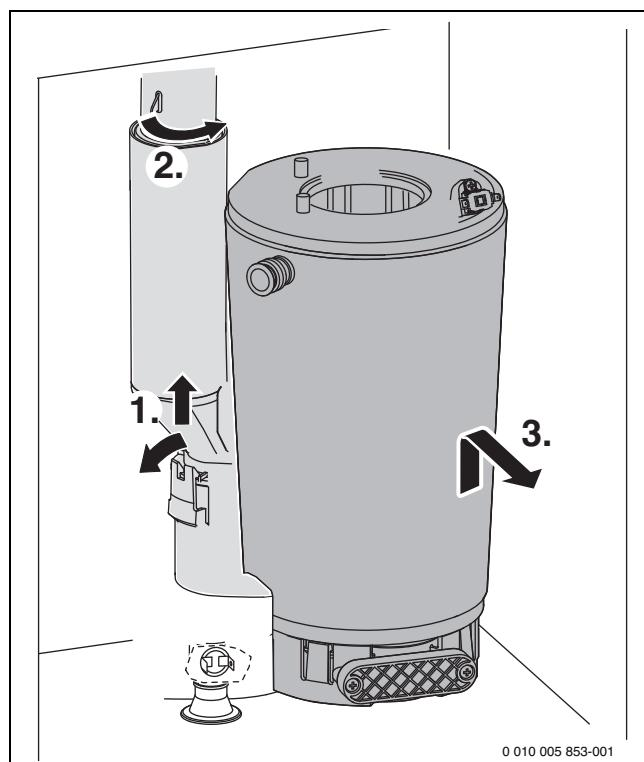
Рис. 81 Демонтаж теплообменника
