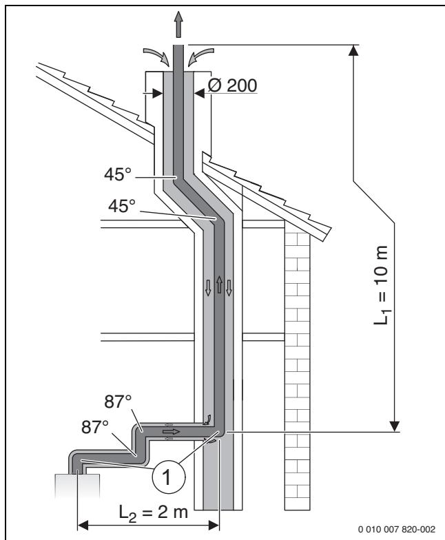
Рис. 17 Монтажная ситуация с отводом дымовых газов в шахте по С93
