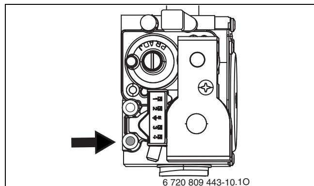
Рис. 52 Штуцер для выполнения замеров давления газа
