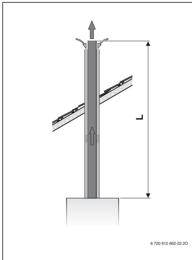
Рис. 14 Вертикальный отвод дымовых газов по С<sub>33</sub>
