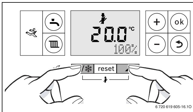
Рис. 53 100 % (максимальная номинальная теплопроизводительность ГВС)
