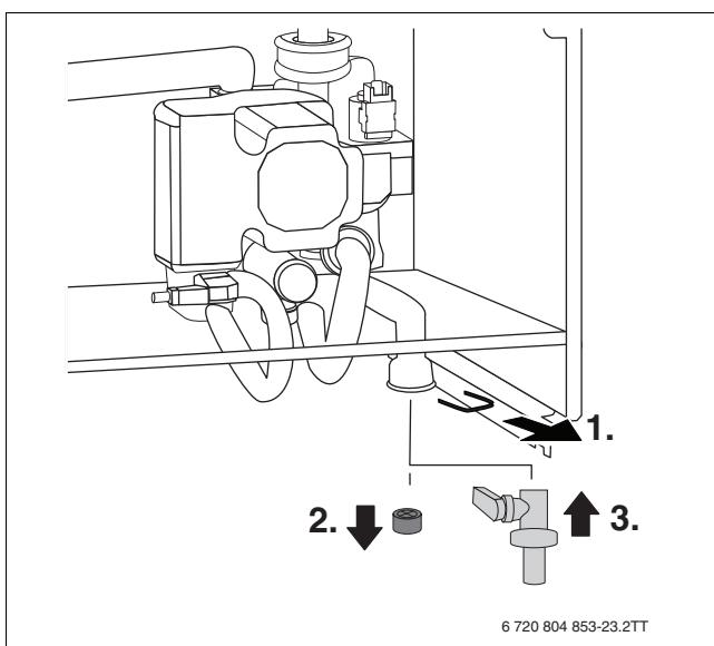
Рис. 26 Установка крана для заполнения и слива
