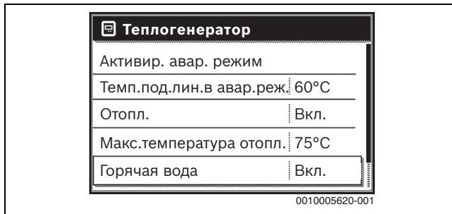
Рис. 8 Включение приготовления горячей воды
