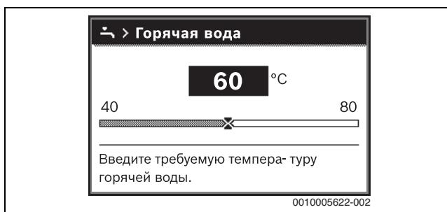
Рис. 9 Установка максимальной температуры горячей воды
