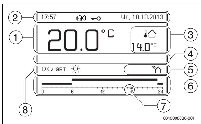
Рис. 3 Условные обозначения в стандартной индикации (вариант экрана)
