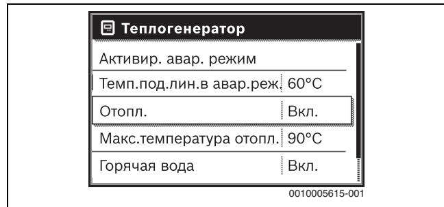
Рис. 5 Включение отопления
