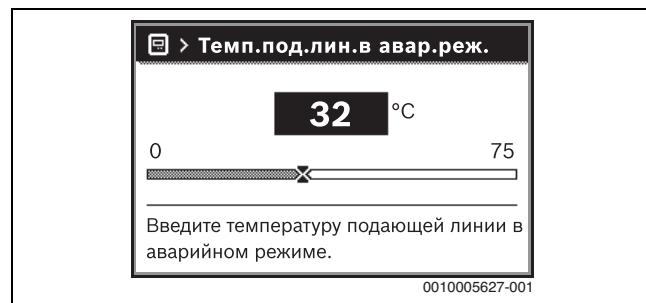
Рис. 10 Температура подающей линии для аварийного режима
