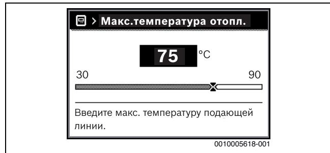
Рис. 7 Установка максимальной температуры подающей линии
