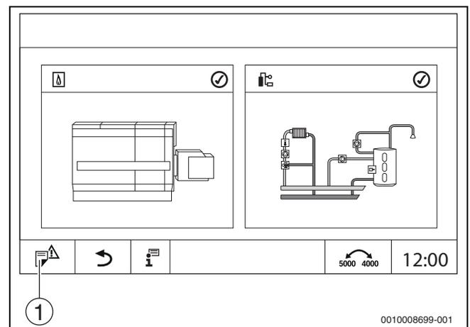
Рис. 34 Вызов индикации неисправностей
