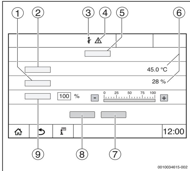
Рис. 14 Индикация Тест дымовых газов > настройки котла
