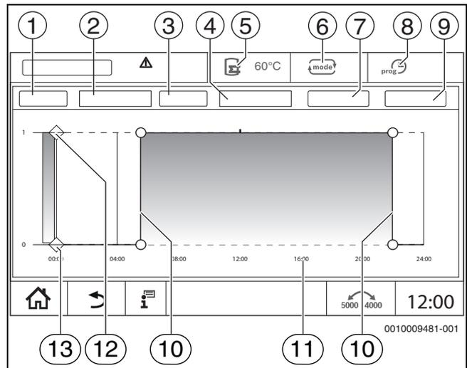
Рис. 28 Программа работы циркуляционного насоса
