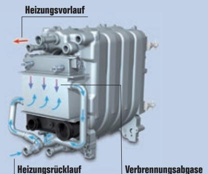
Die moderne und hocheffiziente Brennwerttechnik des Logano plus GB125 zieht auf intelligente Weise zusätzlichen Wärmegewinn aus der Energie der Verbrennungsabgase, die durch Kondensation im Brennwert-Wärmetauscher abgekühlt werden. Dadurch erreicht er einen Normnutzungsgrad von bis zu 104%.
