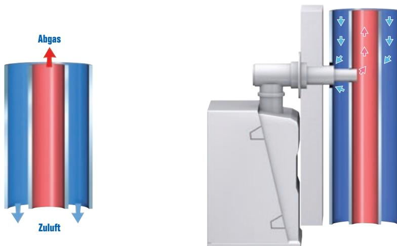
Im Innenrohr steigt das Abgas nach oben und im Aussenrohr wird die Verbrennungsluft zugeführt. Dieses steckfertige Rohr-in-Rohr-System macht den raumluft unabhängigen Betrieb eines Brennwert-Heizkessels besonders leicht.
