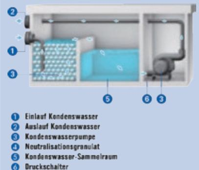
Neutralisationseinrichtung RNA-2 für Öl-Brennwertanlagen im mittleren Leistungsbereich
