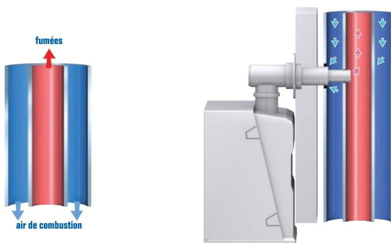
Les fumées montent par le tube interne et l'air de combustion est alimenté par le tube externe. Ce système tube dans tube prêt à l'emploi facilite beaucoup le fonctionnement type ventouse d'une chaudière à condensation.
