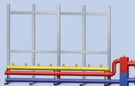
2° étape : mise en place des différents éléments du groupe de raccordement
