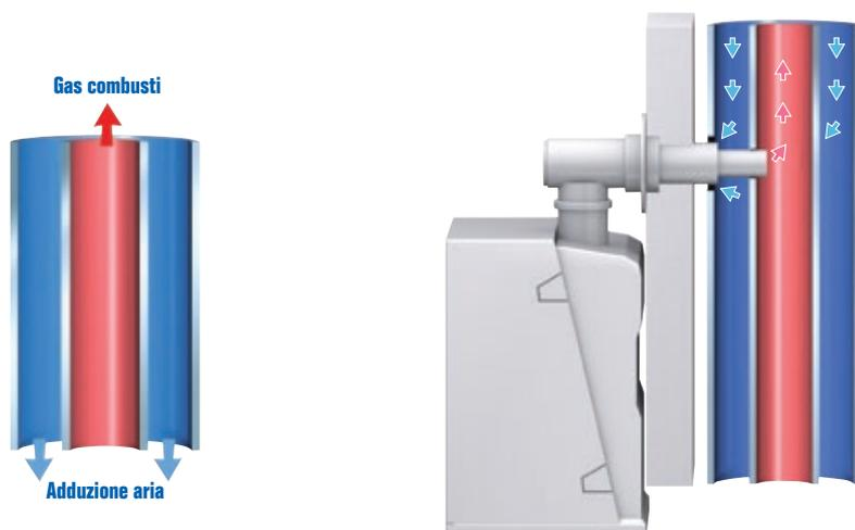
I gas combusti salgono verso l'alto nel tubo interno, mentre l'aria comburente entra attraverso il tubo esterno. Questo sistema coassiale (tubo-nel-tubo) rende l'esercizio indipendente dall'aria ambiente delle caldaie a condensazione particolarmente semplice, perché è subito pronto per essere montato.
