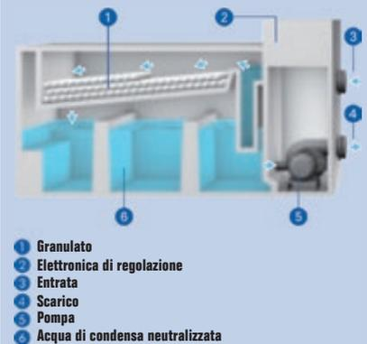
Dispositivo di neutralizzazione NE1.1 per caldaie a condensazione a gas fino a ca. 850 kW
