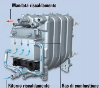
L'attuale ed altamente efficiente tecnica a condensazione della Logano plus GB125 ricava, in modo intelligente, ulteriore calore dall'energia proveniente dai gas di combustione, che vengono raffreddati nello scambiatore di calore mediante la condensazione. In questo modo si ottiene un rendimento medio normalizzato fino al 104%.
