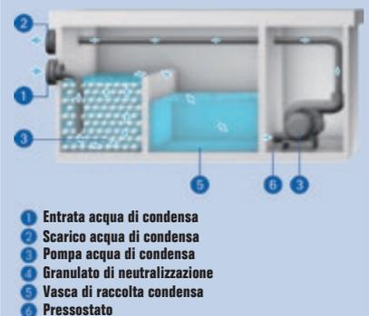
Dispositivo di neutralizzazione RNA-2 per impianti a condensazione a gasolio in campi di potenza di medie dimensioni
