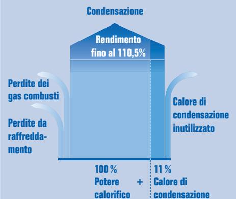
Con lo sfruttamento del calore di condensazione contenuto nei gas combustibili è possibile, con riferimento al potere calorifico (Hi), ottenere rendimenti normalizzati superiori al 100%. Nel caso della caldaia murale Logamax plus GB162, grazie alla tecnica a condensazione, ciò significa raggiungere rendimenti normalizzati del 110%.
