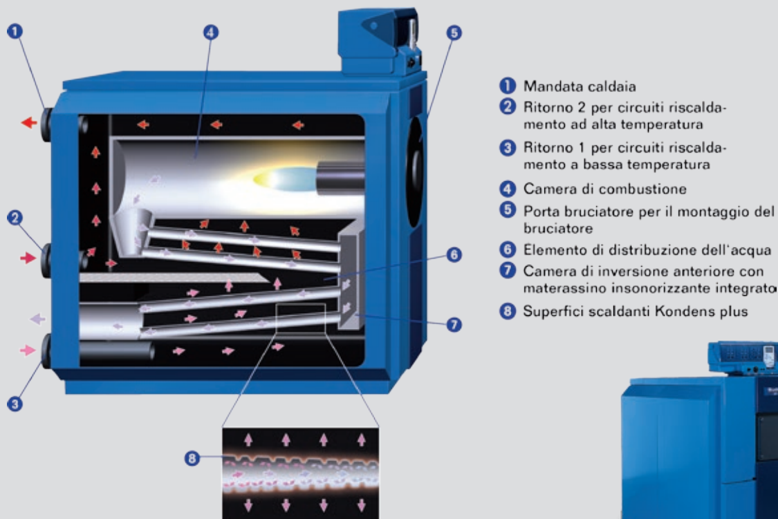
Caldaia a condensazione Logano plus SB625
