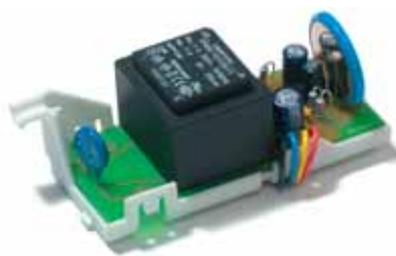
Moduli a innesto per l'alimentazione di tensione
