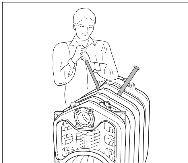
Σχ. 27 Αποσυναρμολόγηση του κορμού λέβητα
