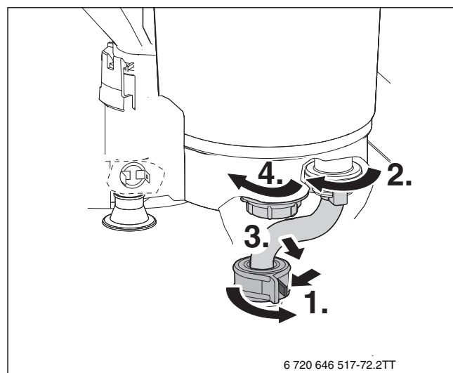
Rys. 120 Wykręcenie nakrętki i poluzowanie rury powrotu
