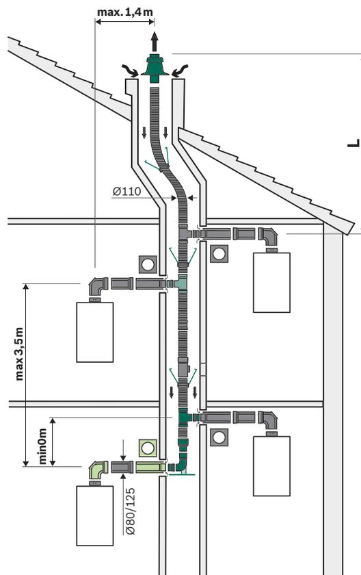
**Gruppi generatori di calore a parete con Q<sub>n,max</sub> entro i 30 kW, per sistema fumario di scarico collettivo tipo C(14)3x - Ø80/125-110 mm, in PP flessibile grigio in camino, in pressione; con ritorno condensa in caldaia <sup>(1)</sup>**
