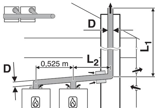
Lunghezze equivalenti massime ammesse per sistemi modulari di caldaie Logamax plus GB272, in PRESSIONE NEGATIVA, con collettori di scarico fumi in PPTI rigido, tipo B23p, in linea TL
