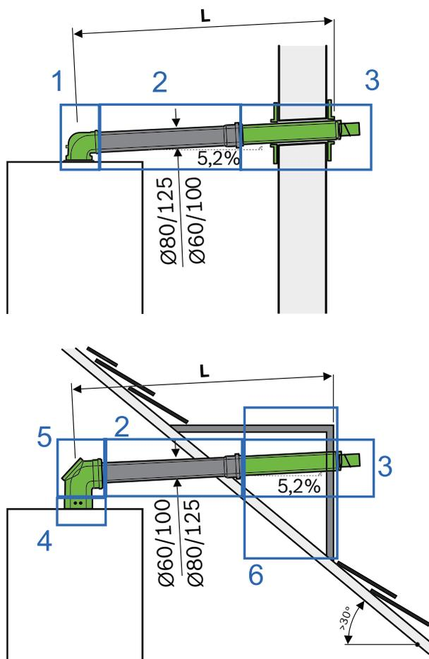
**Kit base in configurazione C13x, a parete o tetto inclinato - Ø60/100 mm, in PP/Met. bianco**
