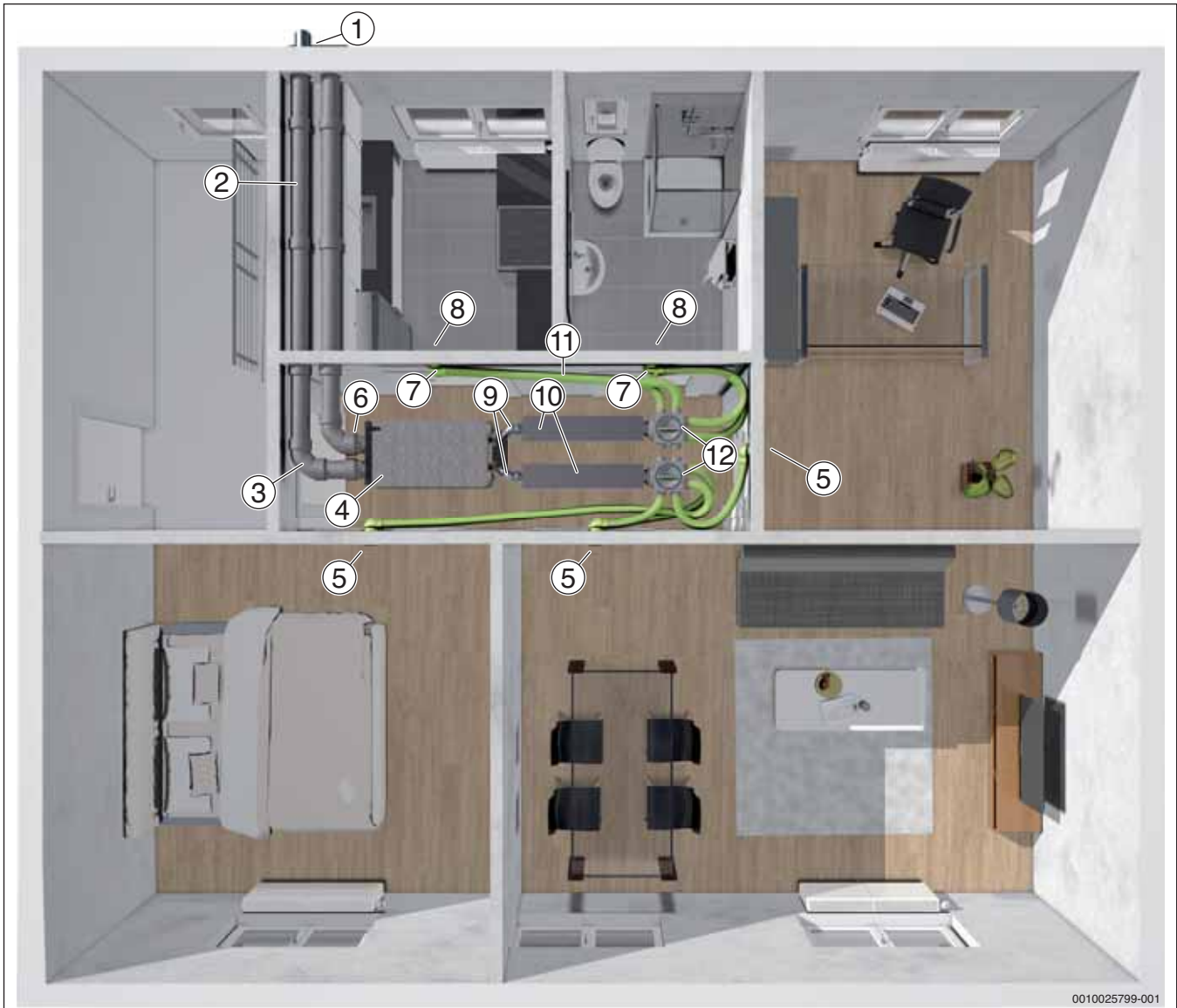
Fig. 23 Esempio di impianto con accessori – installazione a soffitto (ad es. vecchio edificio)
