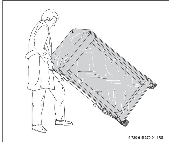
*Fig. 4* Posa dell'accumulatore-produttore di acqua calda
