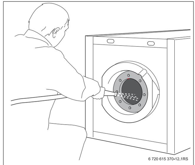
Fig. 14 Pulizia a spruzzo dell'accumulatore-produttore di acqua calda
