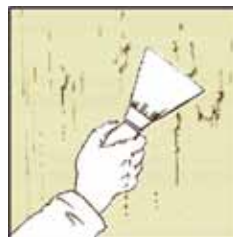
24/1 Preparazione delle pareti
