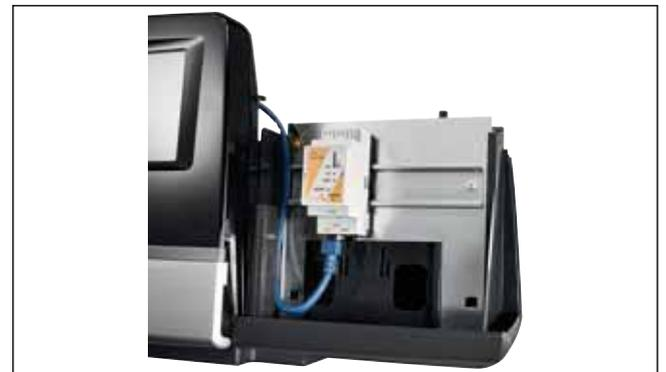
Fig. 76 IP-Gateway per l'utilizzo di Control Center CommercialPLUS (montaggio su modulo guida profilata FM-RM)
