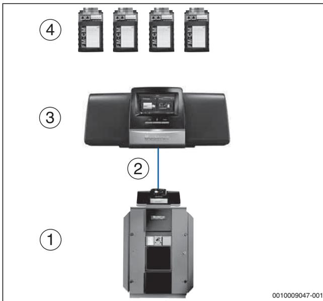
Fig. 29 Termoregolatore Logamatic 5311 per caldaia con bruciatore fornito da terze parti
