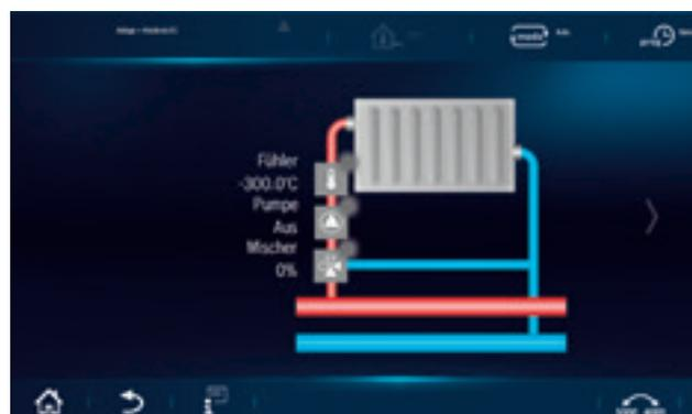
Monitoraggio e regolazione manuale del circuito di riscaldamento
