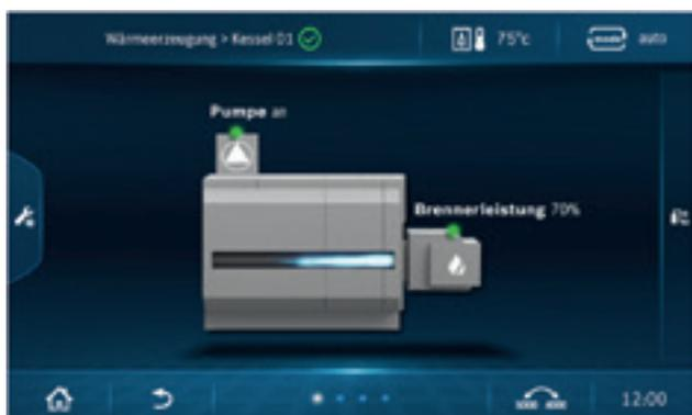
Monitoraggio e regolazione manuale della caldaia
