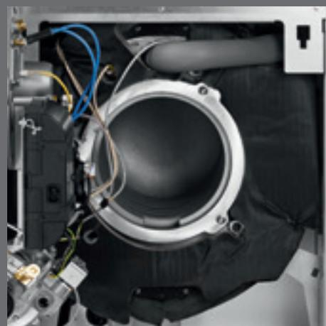
Il bruciatore di premiscelazione a gas modulante di ultima generazione permette alla caldaia di raggiungere una modulazione di 1:7, adattando i consumi ai reali fabbisogni e consentendo così la riduzione dei consumi energetici e dei relativi costi fino al 20% rispetto alle caldaie a gas di precedenti generazioni.
