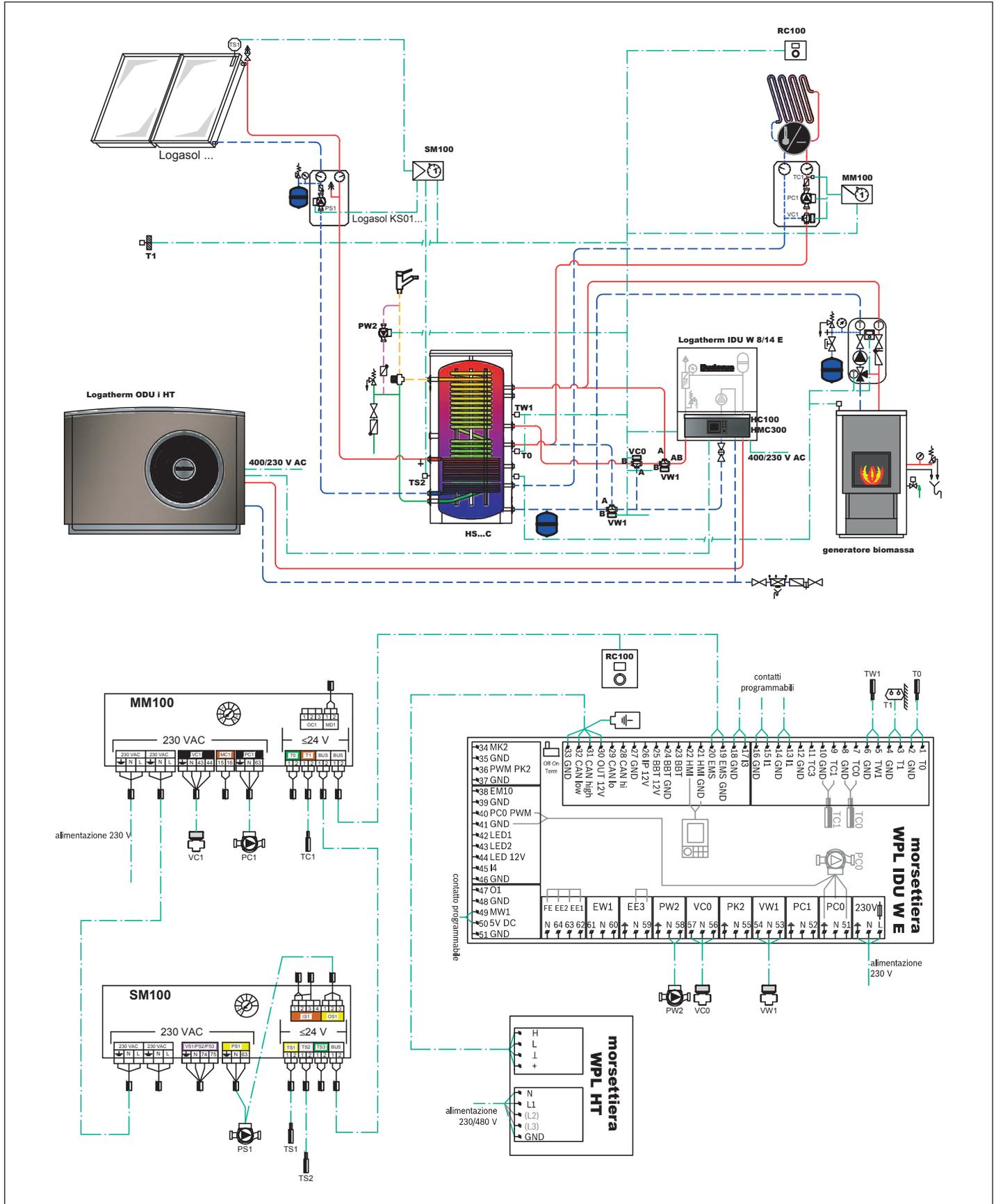
Fig. 35 Schema 9: Impianto multi energia, WPL HT, accumulatore ibrido HS, integrazione da solare termico e biomassa
