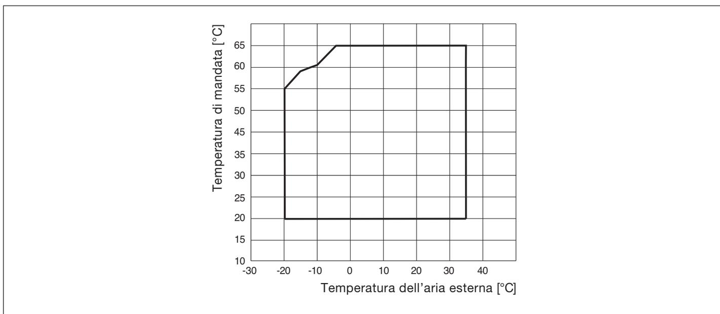
Fig. 9 Limiti di funzionamento WPL HT
