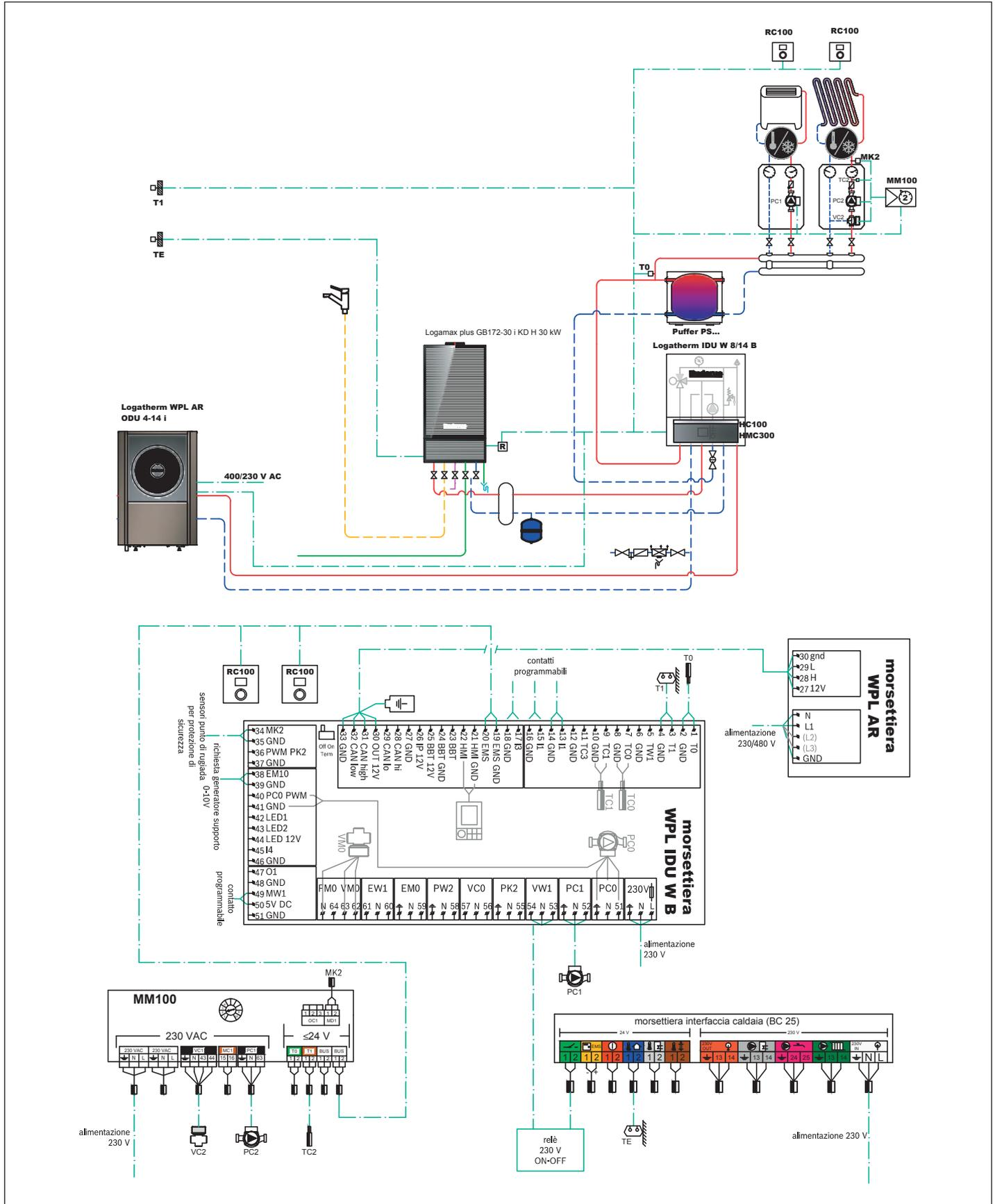
Fig. 28 Schema 2: Impianto ibrido con caldaia istantanea, WPL AR
