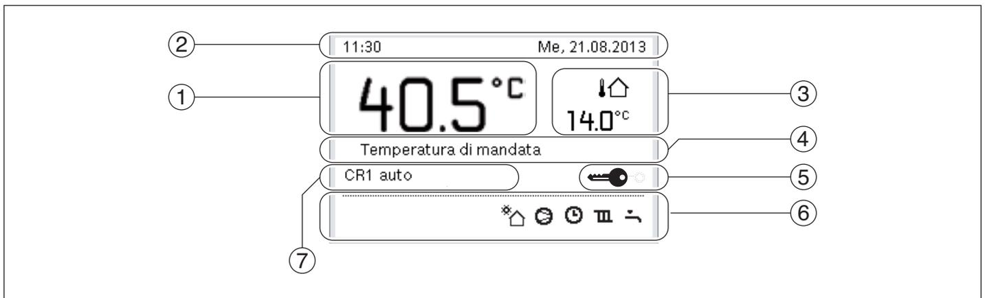
Fig. 20 Display dell'unità di controllo HMC300
