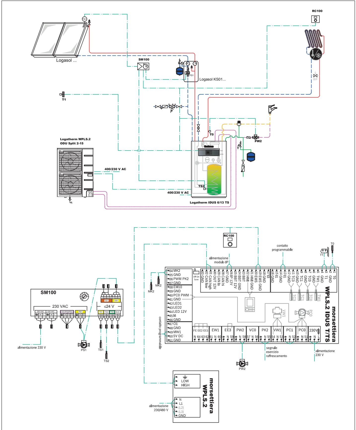
Fig. 32 Schema 6: Impianto monoenergetico, WPLS.2, unità compatta IDUS TS con solare termico
