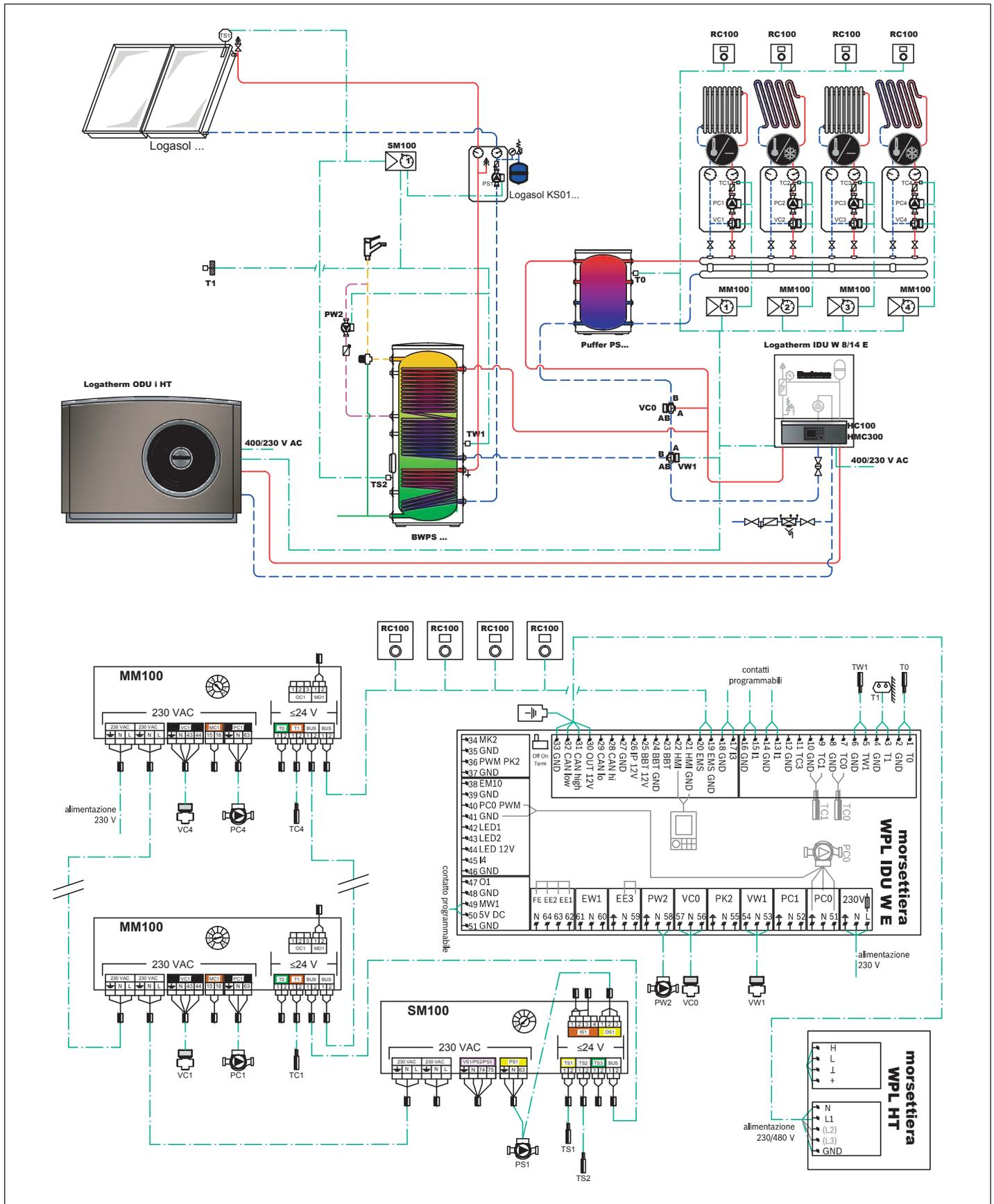
Fig. 30 Schema 4: Impianto monoenergetico, WPL HT, bollitore bivalente con solare termico
