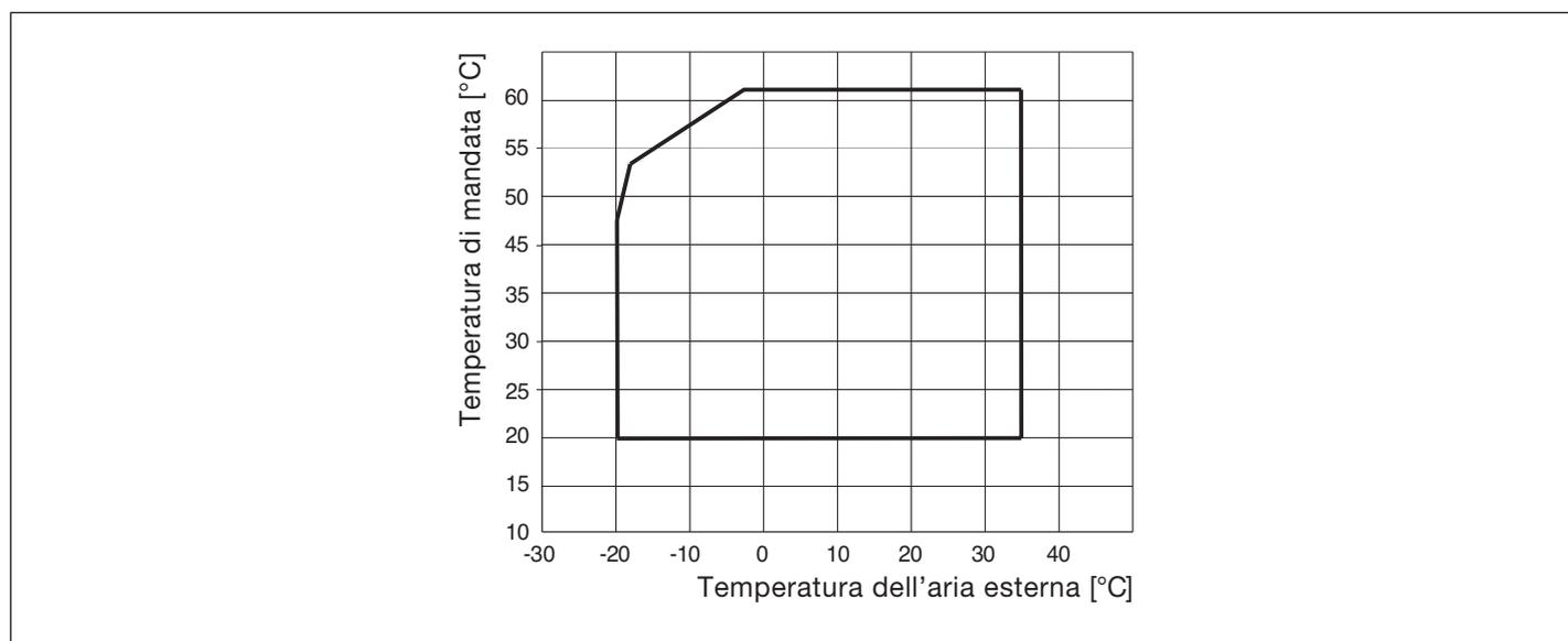
Fig. 7 Limiti di funzionamento ODU i
