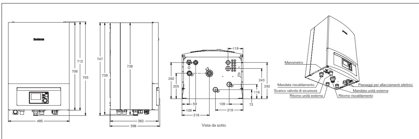
Fig. 15 Dimensioni e attacchi di collegamento unità IDU W-E
