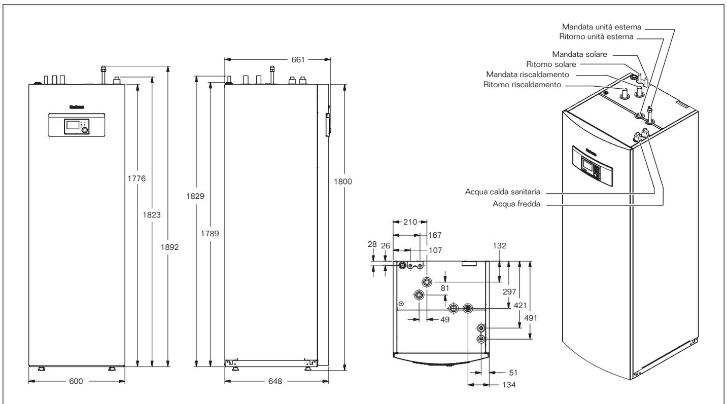
Fig. 16 Dimensioni e attacchi di collegamento unità IDU W-T/TS e IDUS-T/TS
