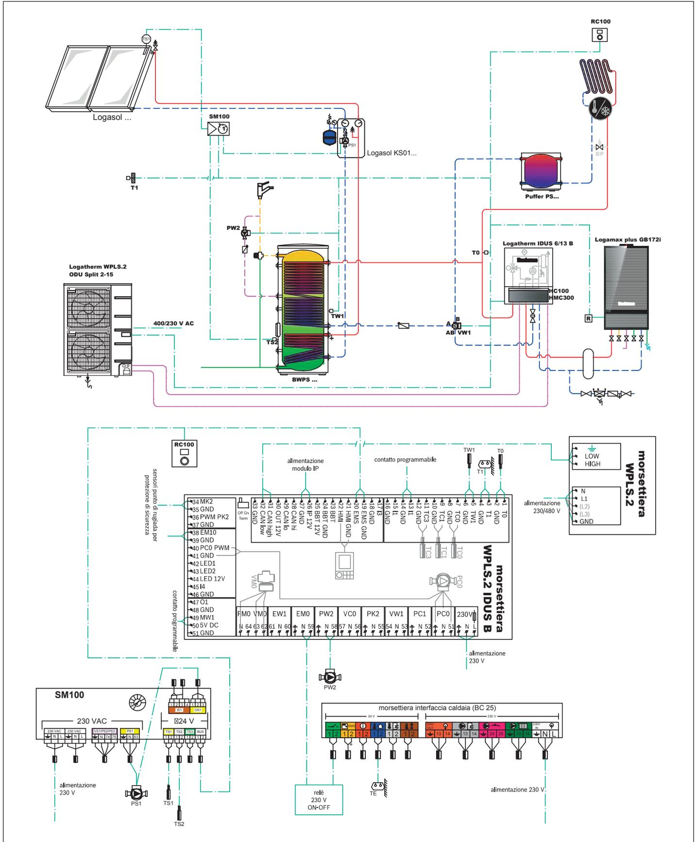
Fig. 29 Schema 3: Impianto ibrido, WPLS.2, bollitore bivalente con solare termico
