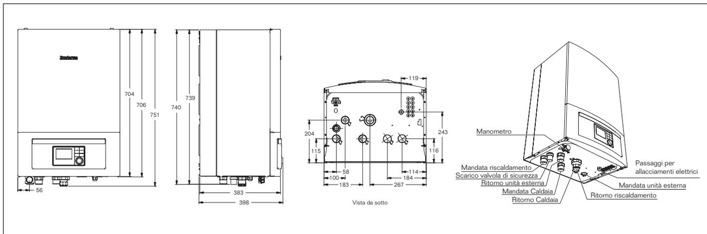
Fig. 13 Dimensioni e attacchi collegamento unità IDU W-E
