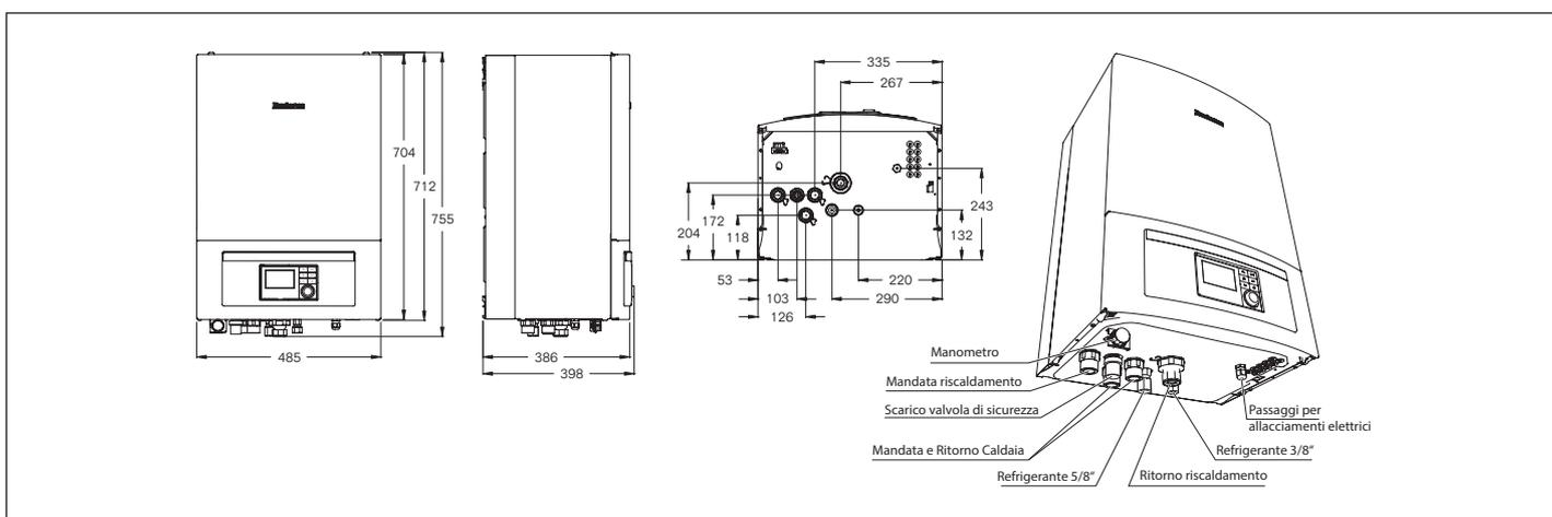
Fig. 12 Dimensioni e attacchi di collegamento unità IDUS-B
