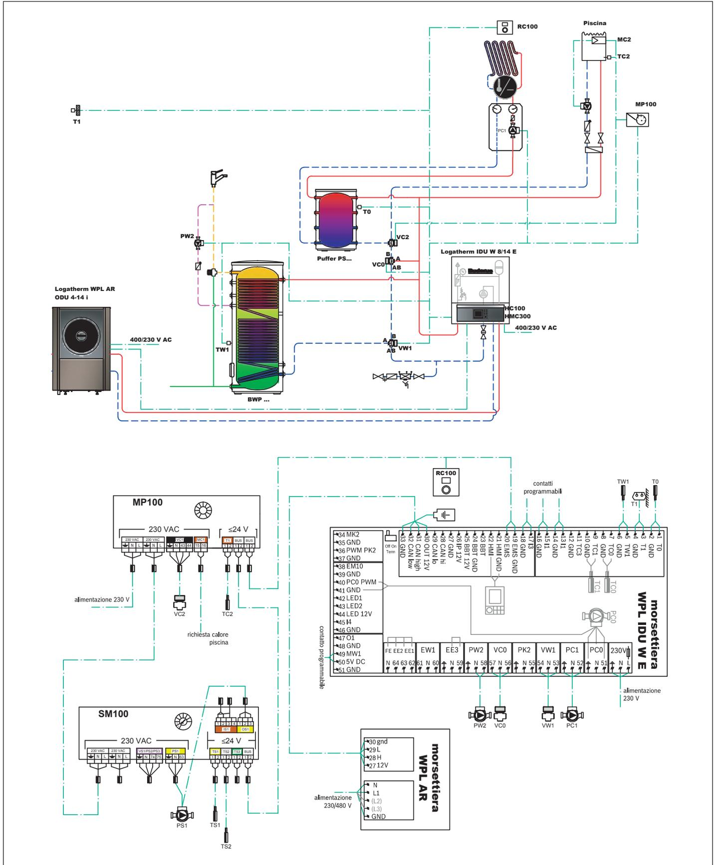
Fig. 34 Schema 8: Impianto monoenergetico, WPL AR, bollitore monovalente, circuito piscina
