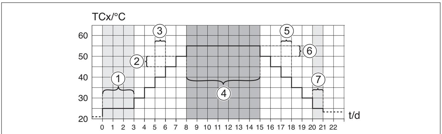
Fig. 23 Rappresentazione dei parametri di asciugatura del massetto impostati di fabbrica:
