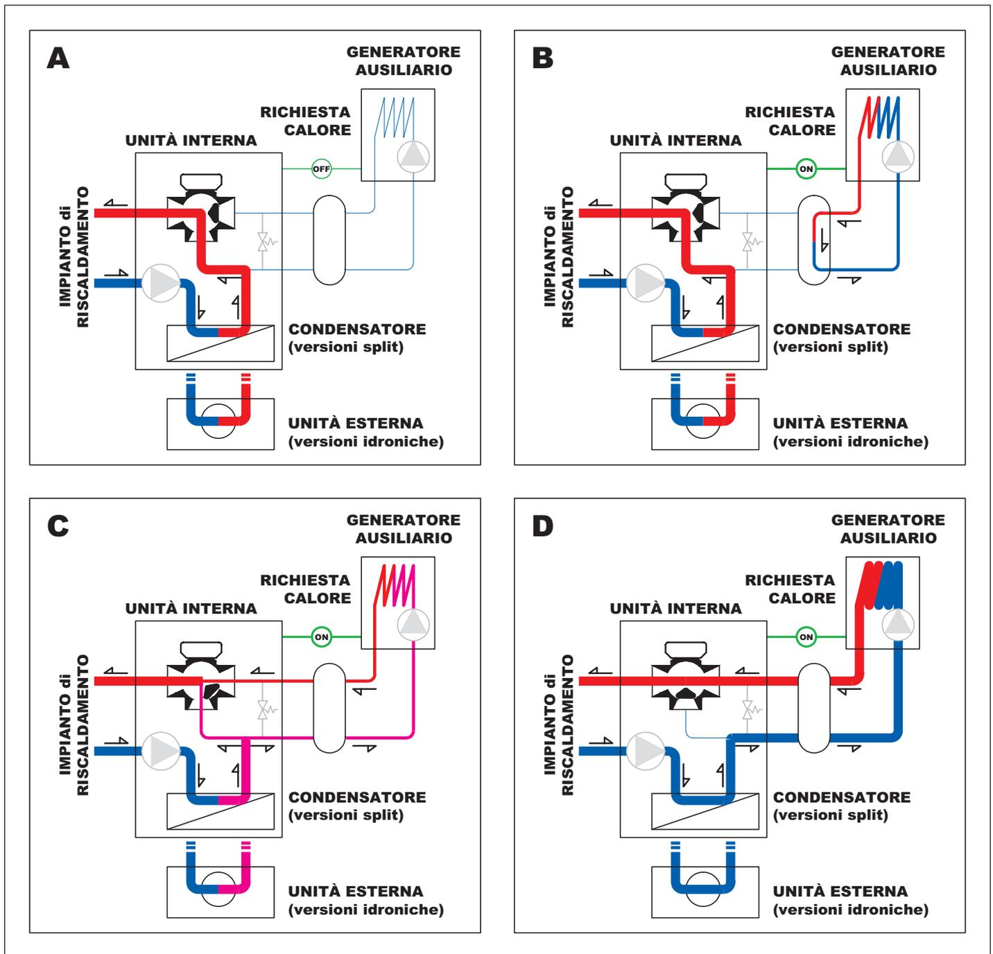
Fig. 10 Funzionamento schematico della valvola di miscelazione delle IDU W-B e IDUS-B.
