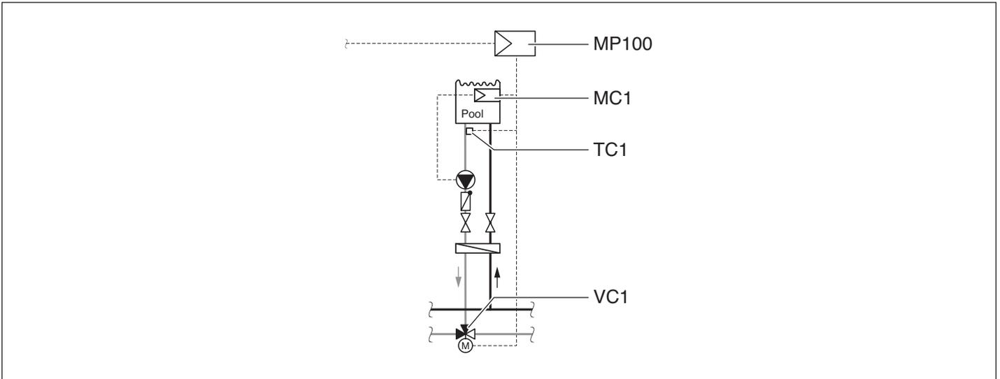
Fig. 25 Esempio di un impianto per piscina
