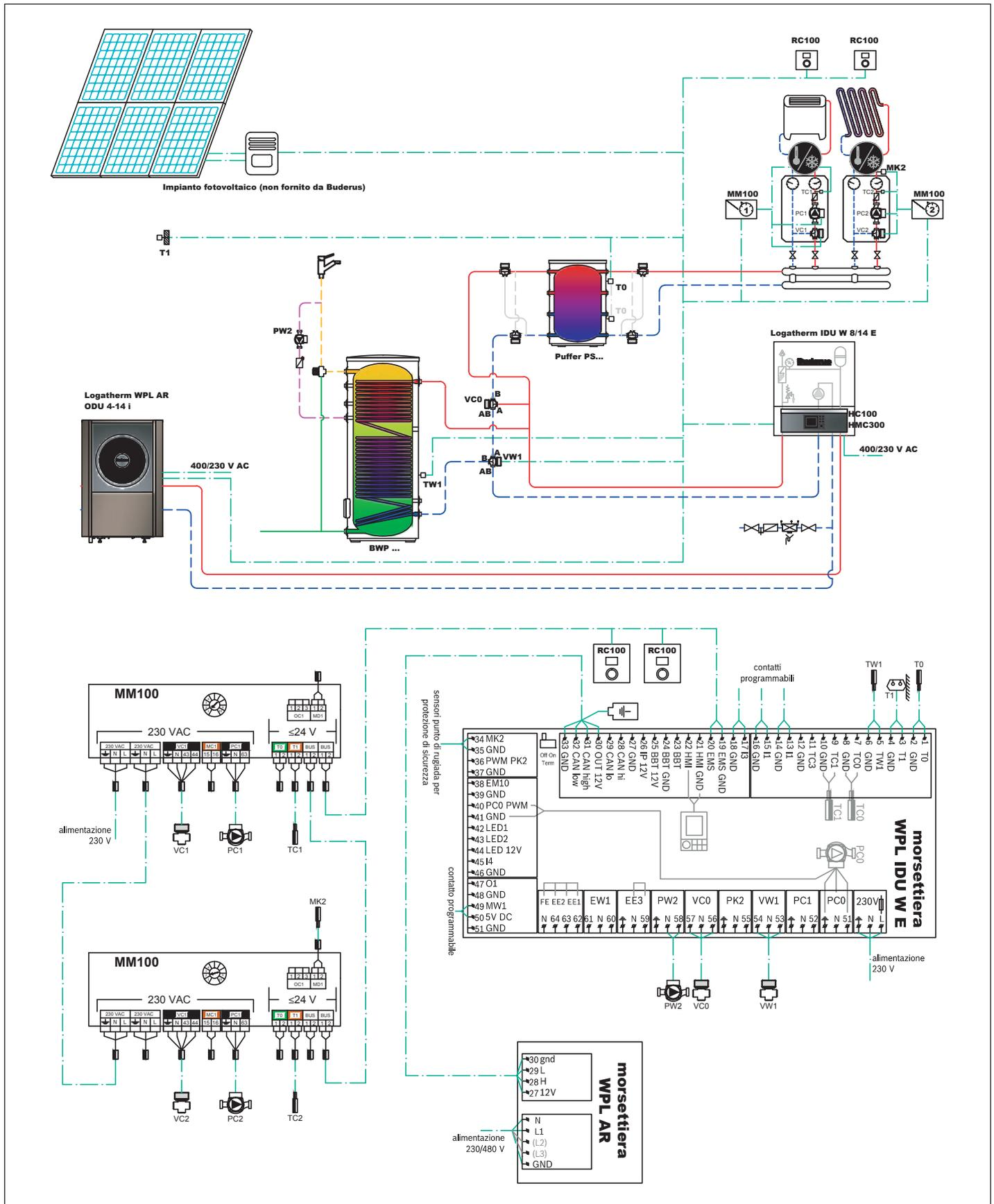
Fig. 31 Schema 5: Impianto monoenergetico, WPL AR, integrazione impianto fotovoltaico
