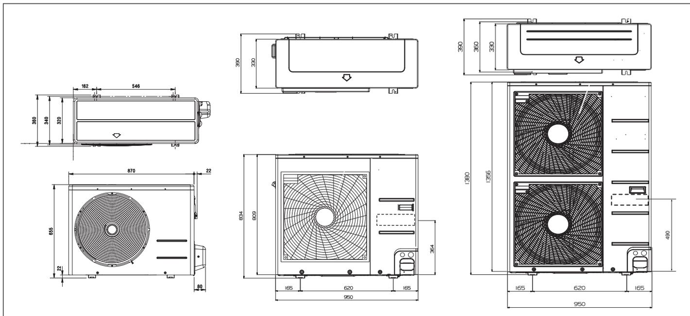
Fig. 4 Dimensioni e collegamento unità esterna Logatherm WPLS.2 (si veda anche Tab. 7)
