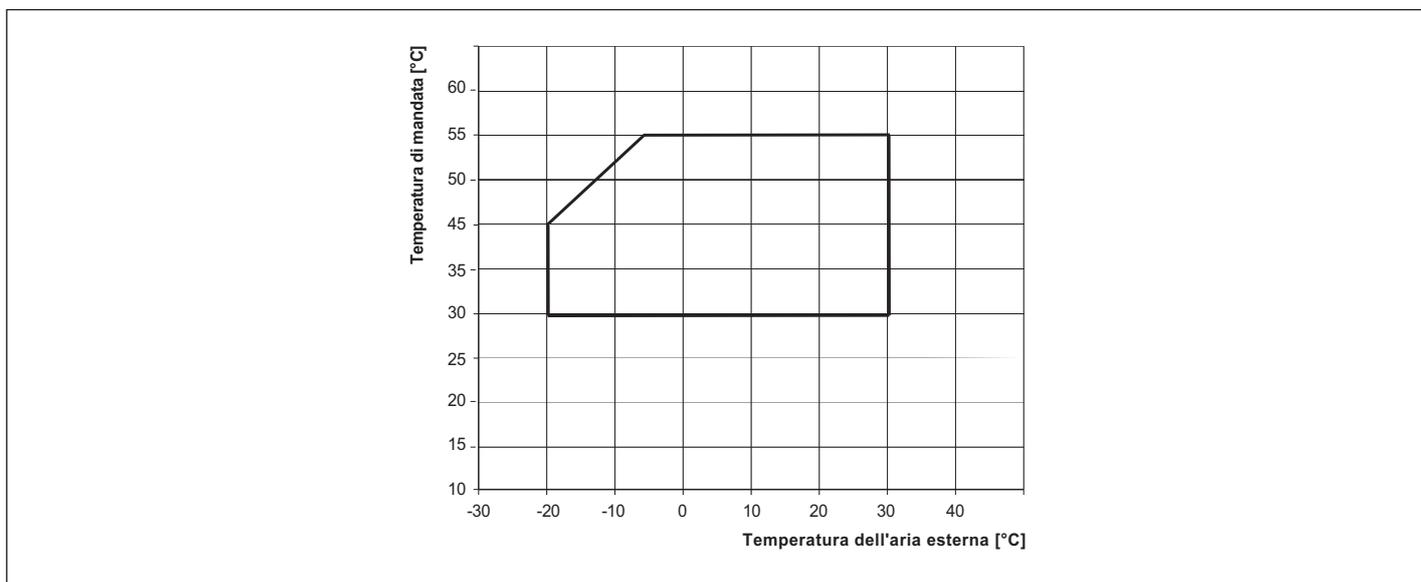
Fig. 5 Limiti di funzionamento ODU Split
