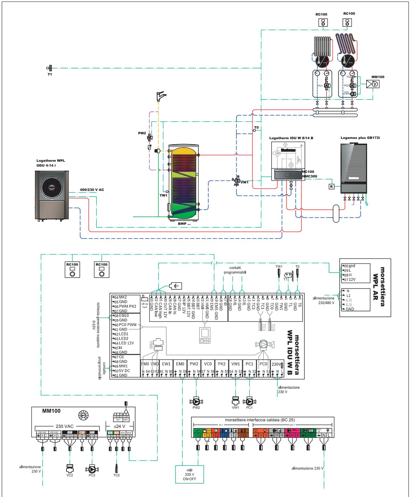
Fig. 27 Schema 1: Impianto ibrido, WPL AR, bollitore monovalente
