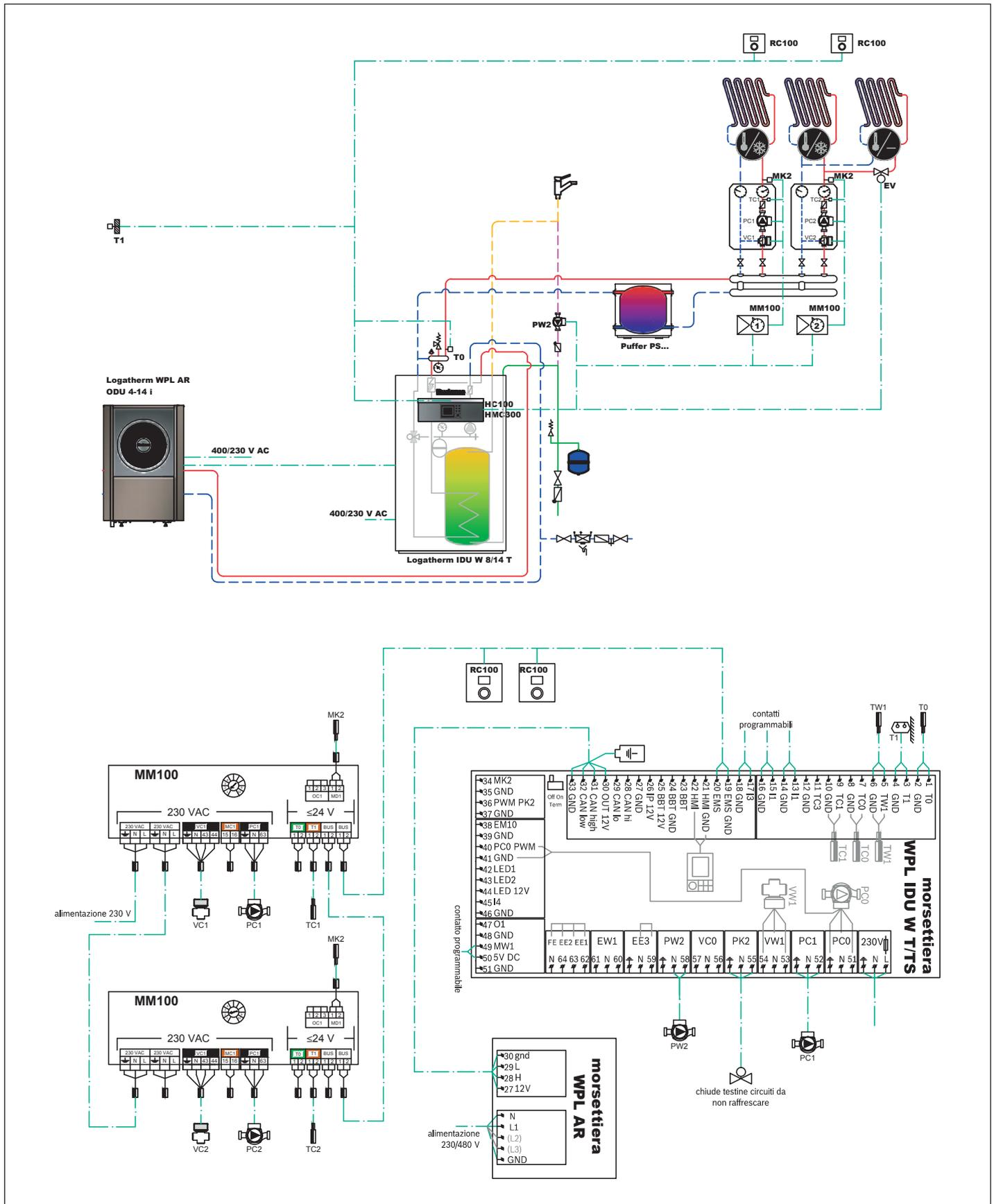
Fig. 33 Schema 7: Impianto compatto WPL AR e unità compatta IDU W T
