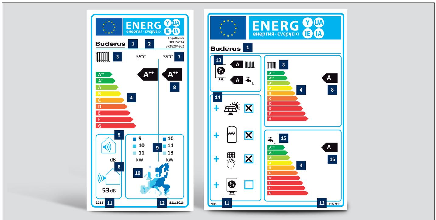
Fig. 2 Esempio di etichetta energetica di una pompa di calore e di un insieme di prodotti per riscaldamento e acqua sanitaria
