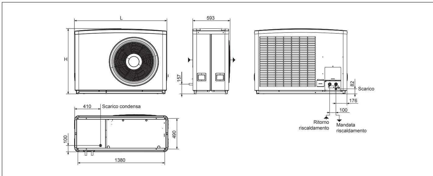
Fig. 8 Dimensioni di ingombro delle pompe di calore ODU i HT (si veda anche Tab. 9)
