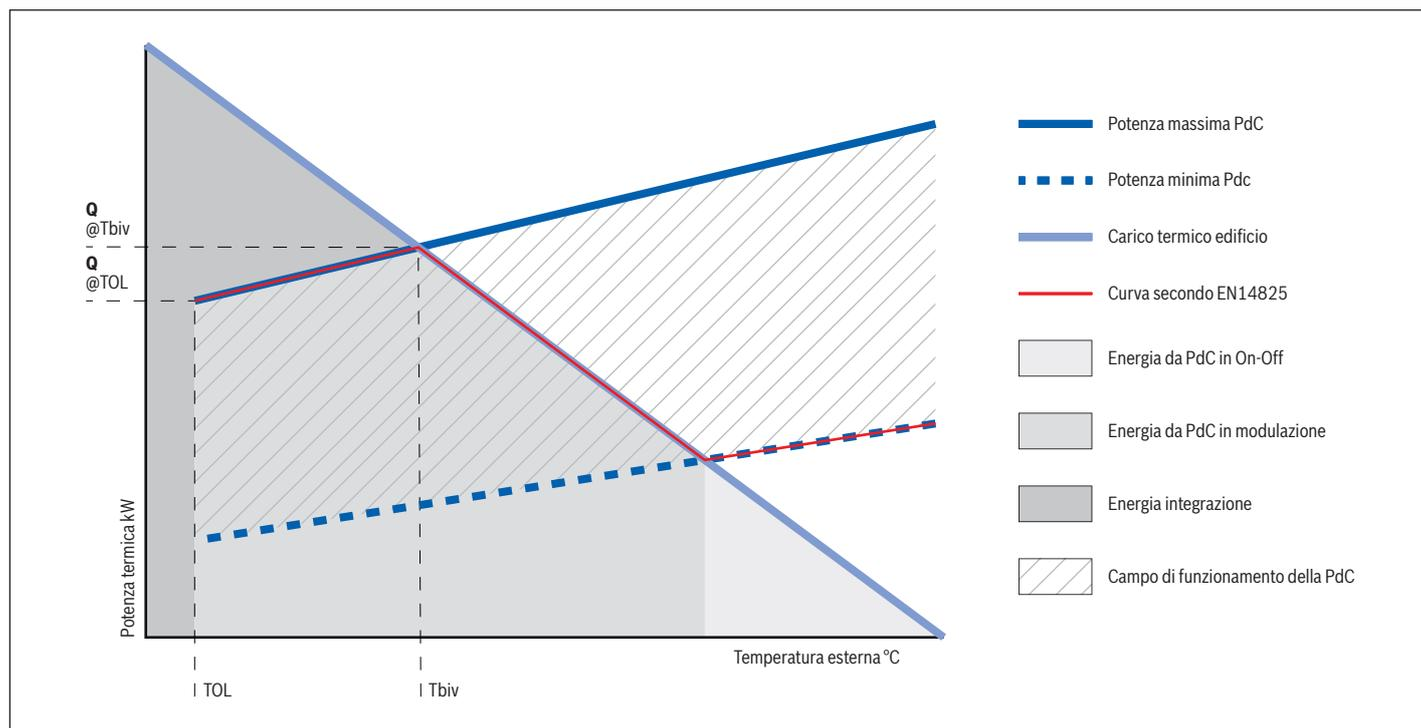
Fig. 3 Grafico delle condizioni di funzionamento di una pompa di calore ad aria, secondo EN 14825
