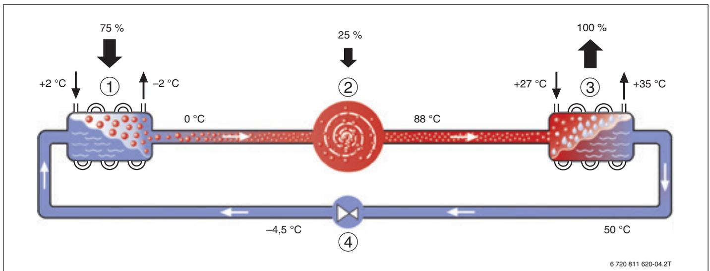
Fig. 1 Rappresentazione schematica del circuito del refrigerante in una pompa di calore
