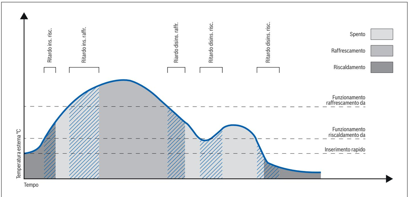
Fig. 22 Rappresentazione della commutazione estate-inverno in base ai parametri impostabili
