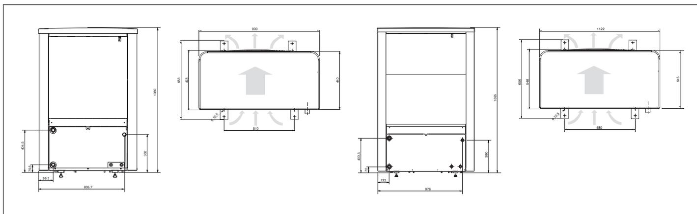
Fig. 6 Dimensioni e collegamento unità esterna ODU i (si veda anche Tab. 8)
