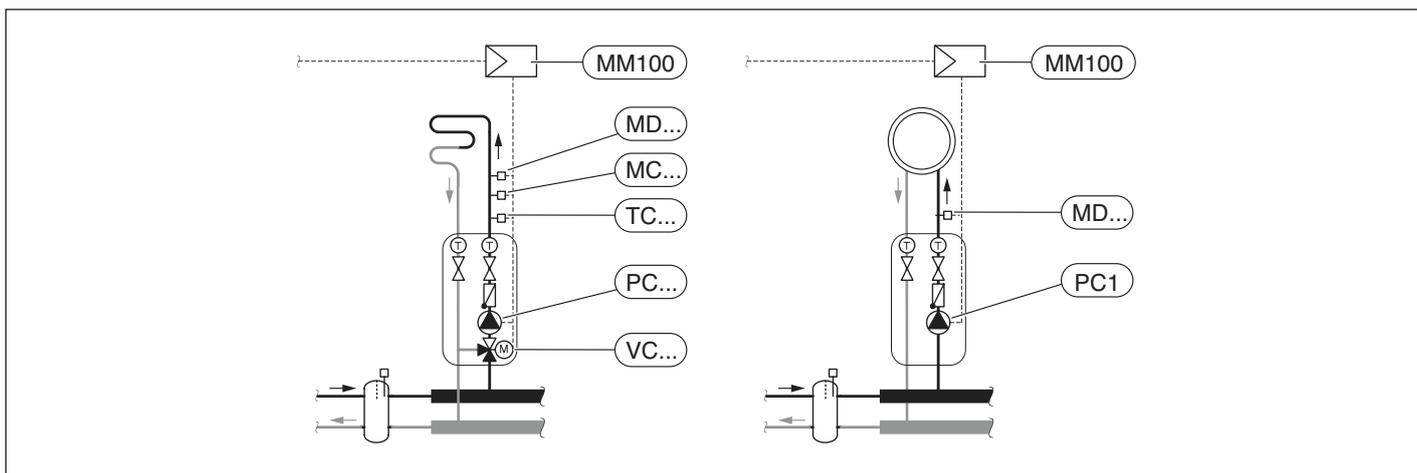
Fig. 24 Possibili circuiti regolati con MM100 in abbinamento a pompa di calore
