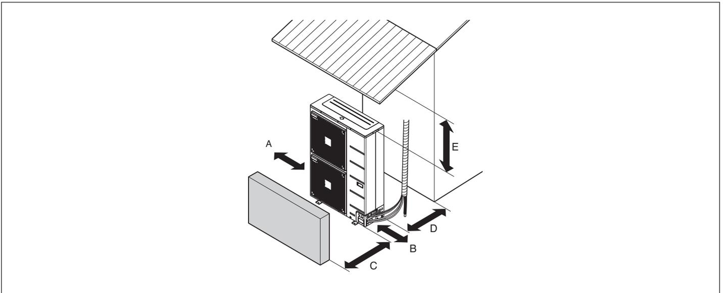
Fig. 17 Distanze di riferimento rispetto all'unità esterna (misure in mm)
