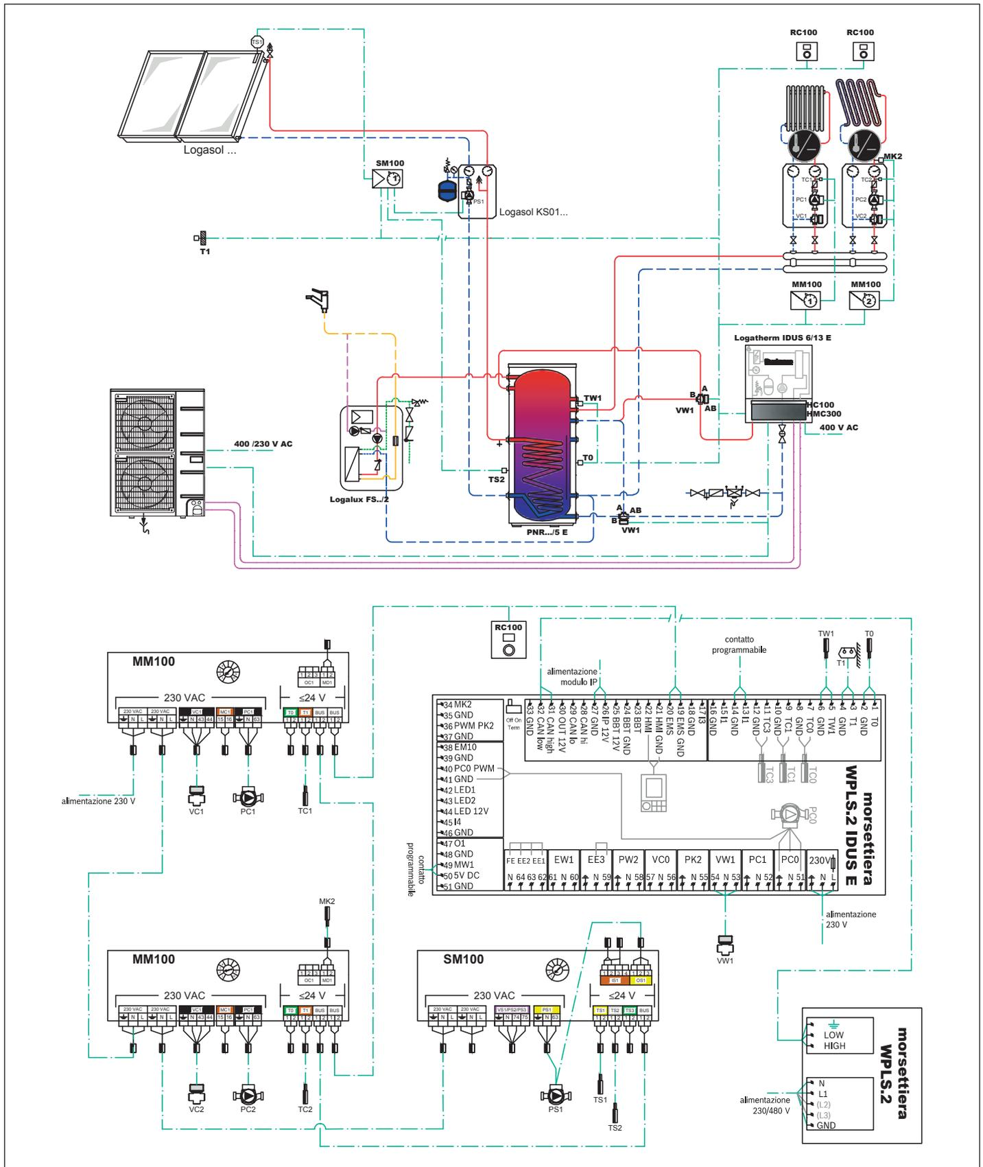
Fig. 36 Schema 10: Impianto monoenergetico, WPLS.2, accumulatore tecnico con produttore istantaneo ACS, integrazione solare
