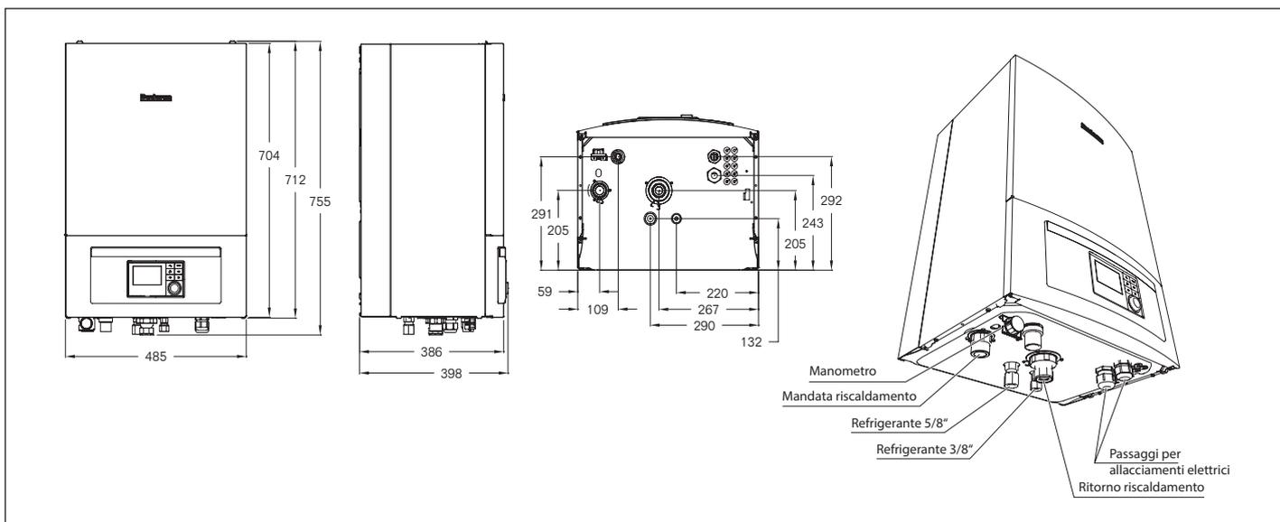
Fig. 14 Dimensioni e attacchi di collegamento IDUS-E
