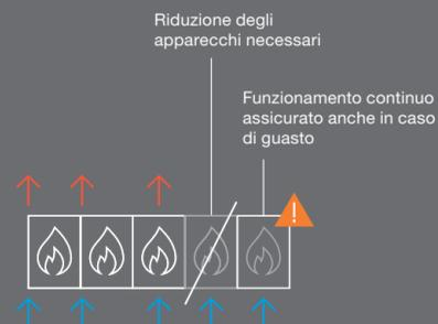
Rispetto ai modelli precedenti, grazie alle maggiori potenze disponibili su singola caldaia, è possibile ridurre il numero di apparecchi necessari per soddisfare il fabbisogno di calore, anche in caso di malfunzionamenti di una singola caldaia.
