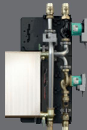
Stazione solare di scarico inerziale Logasol tipo SBP 220/3 senza isolamento, con scambiatore a piastre integrato e circolatori ad alta efficienza
