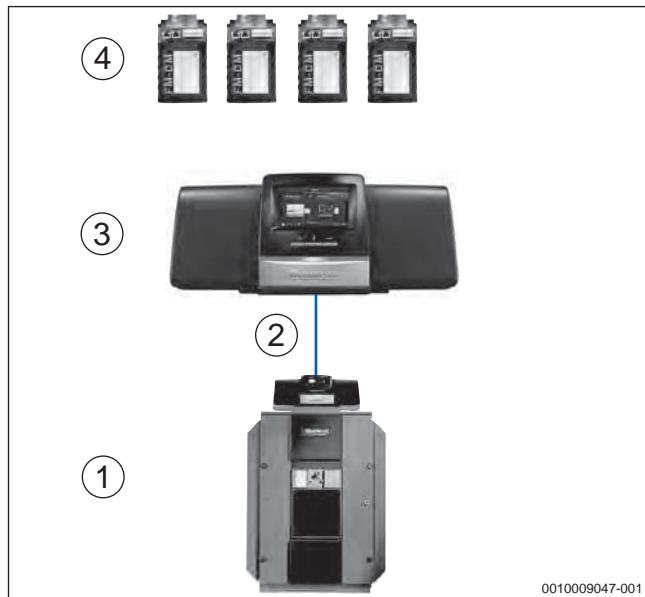
Рис. 29 Система управления Logamatic 5311 для напольных котлов с горелками сторонних производителей
