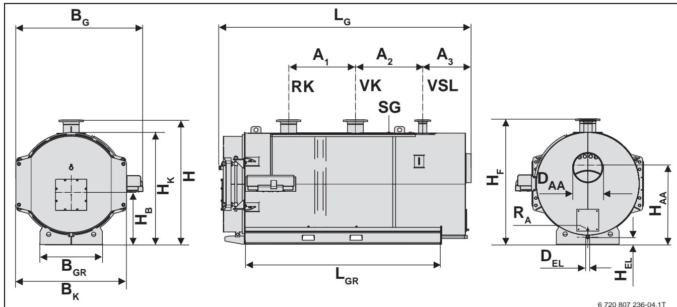
Рис. 7 Размеры Logano SK755 1040 - 1200 кВт
