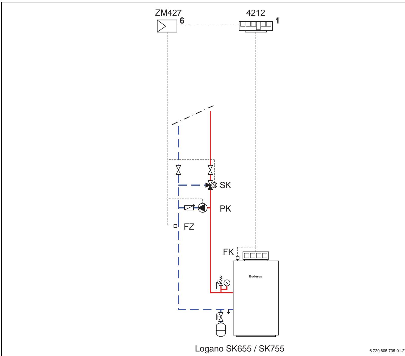
Рис. 29 Пример установки с Logano SK655 или SK755
