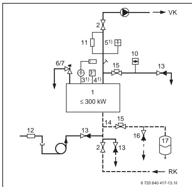
Рис. 23 Приборы безопасности по EN 12828 для котлов  $\leq 300 \text{ кВт}$  с предохранительным ограничителем температуры (STB)  $\leq 110^{\circ}\text{C}$
