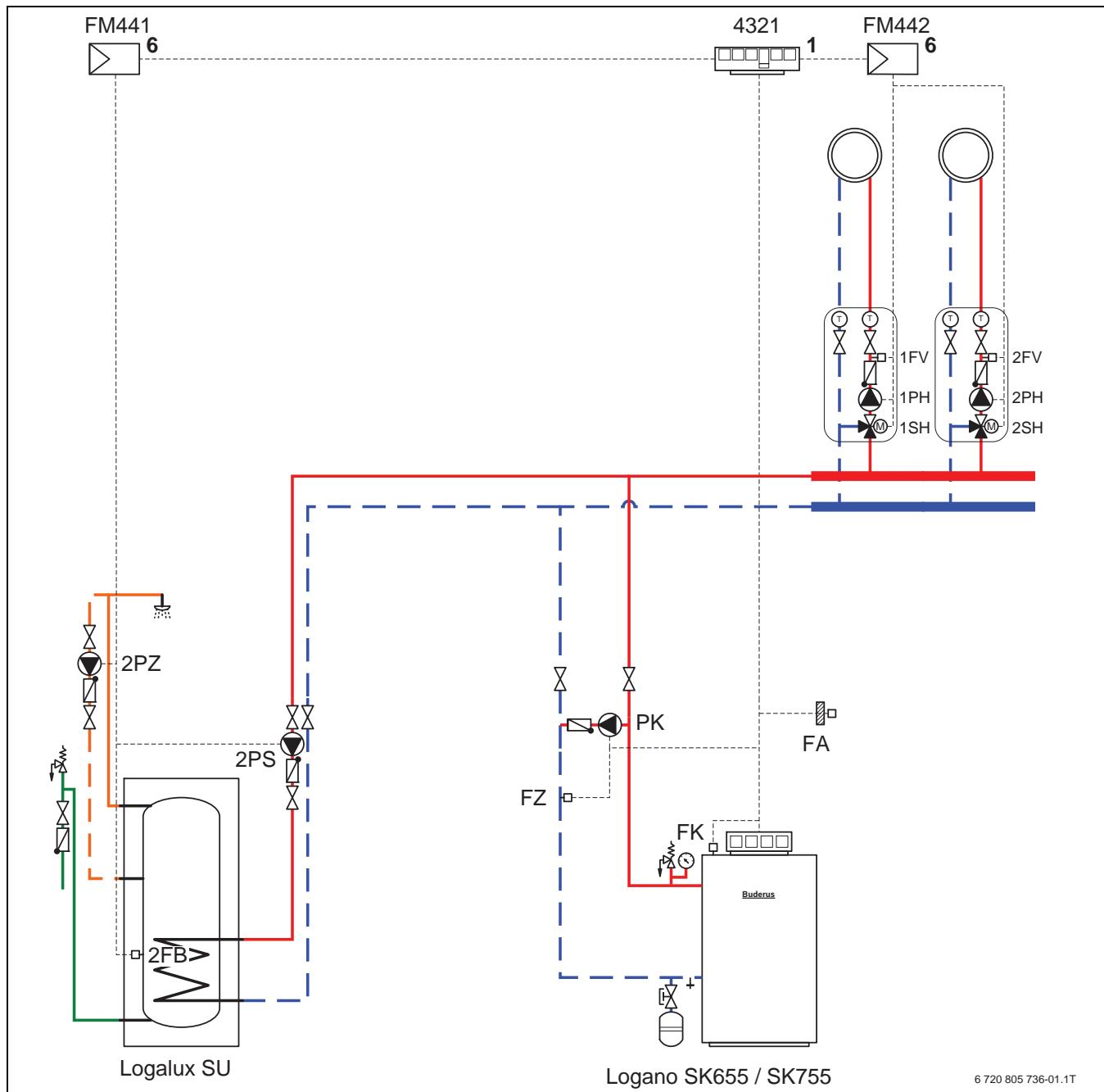
Рис. 31 Пример установки с Logano SK655 или SK755
