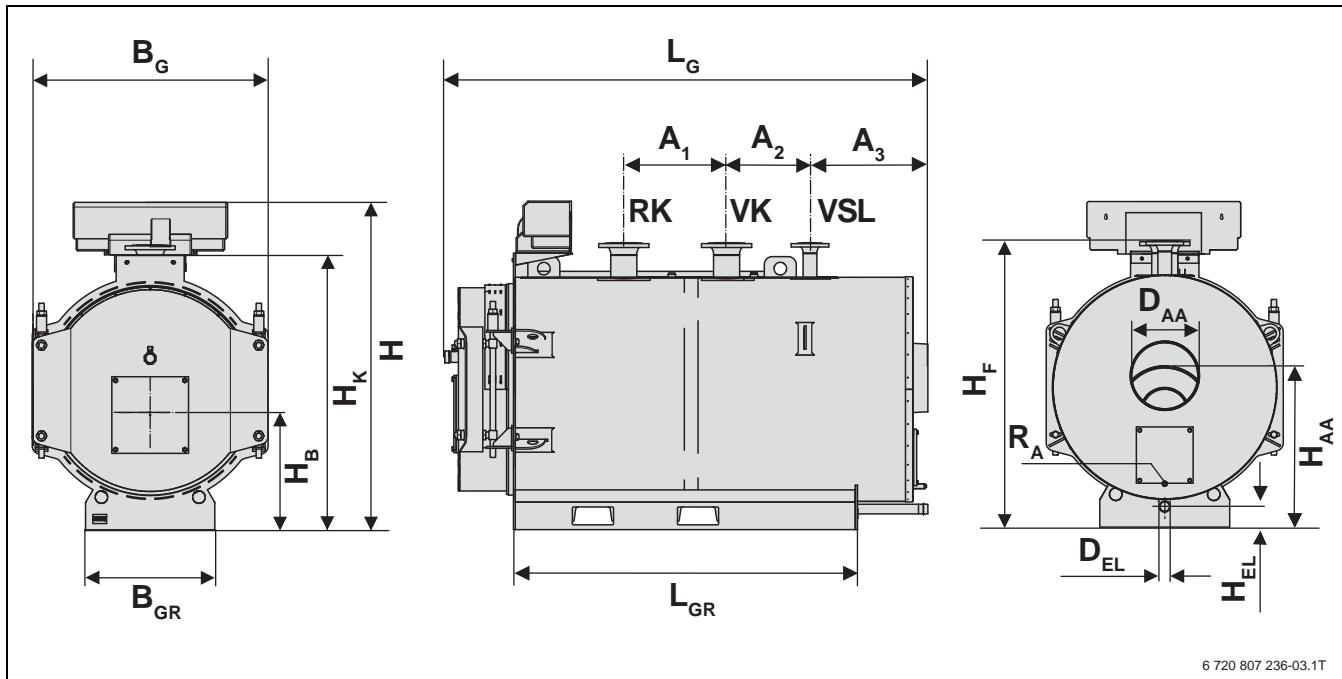
Рис. 5 Размеры Logano SK655 120 - 360 кВт
