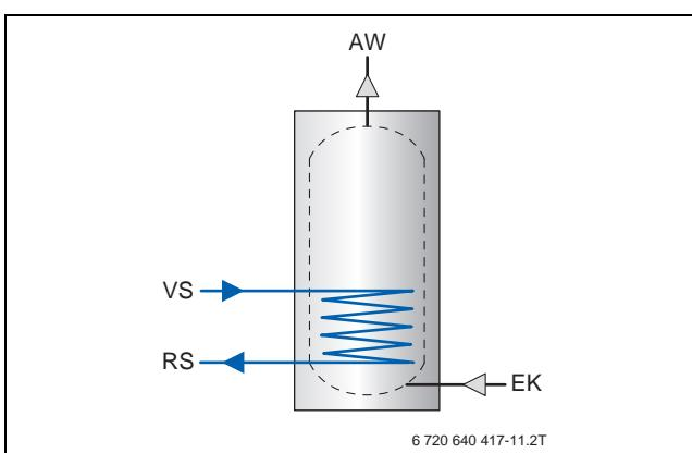
Рис. 21 Приготовление горячей воды по накопительному принципу с внутренним теплообменником
