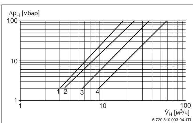
Рис. 9 Гидравлическое сопротивление водяного контура Logano SK655/SK755
