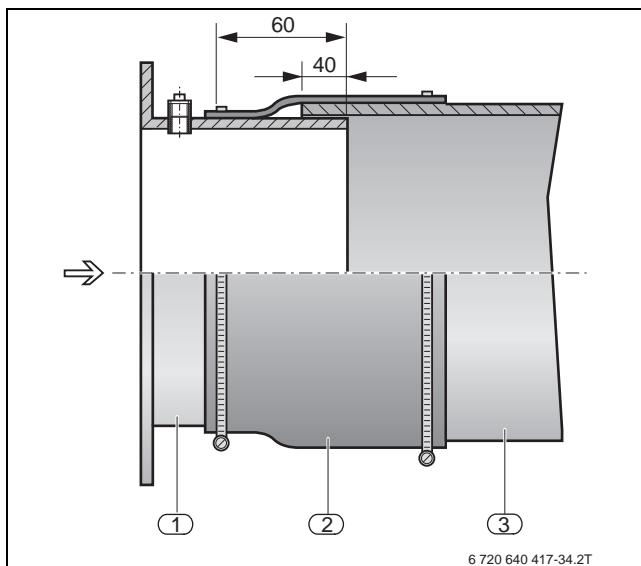
Рис. 40 Уплотнительная манжета дымовой трубы
