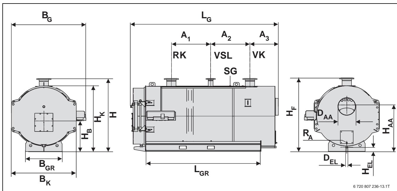
Рис. 8 Размеры Logano SK755 1400 - 1850 кВт
