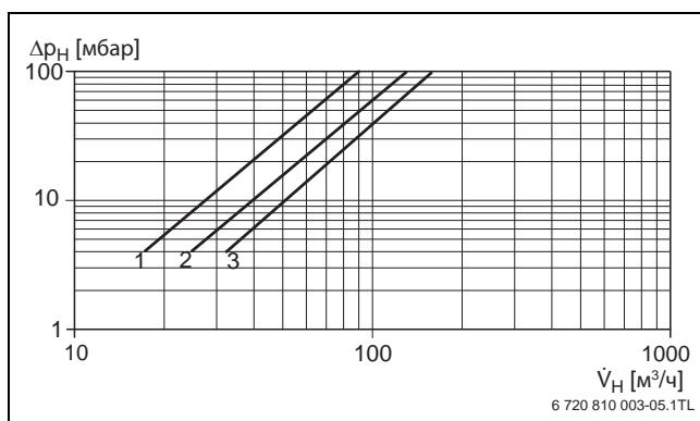
Рис. 10 Гидравлическое сопротивление водяного контура Logano SK755
