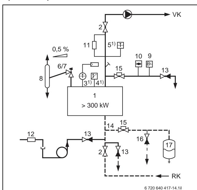
Рис. 24 Приборы безопасности по EN 12828 для котлов  $> 300 \text{ кВт}$  с предохранительным ограничителем температуры (STB)  $\leq 110^{\circ}\text{C}$
