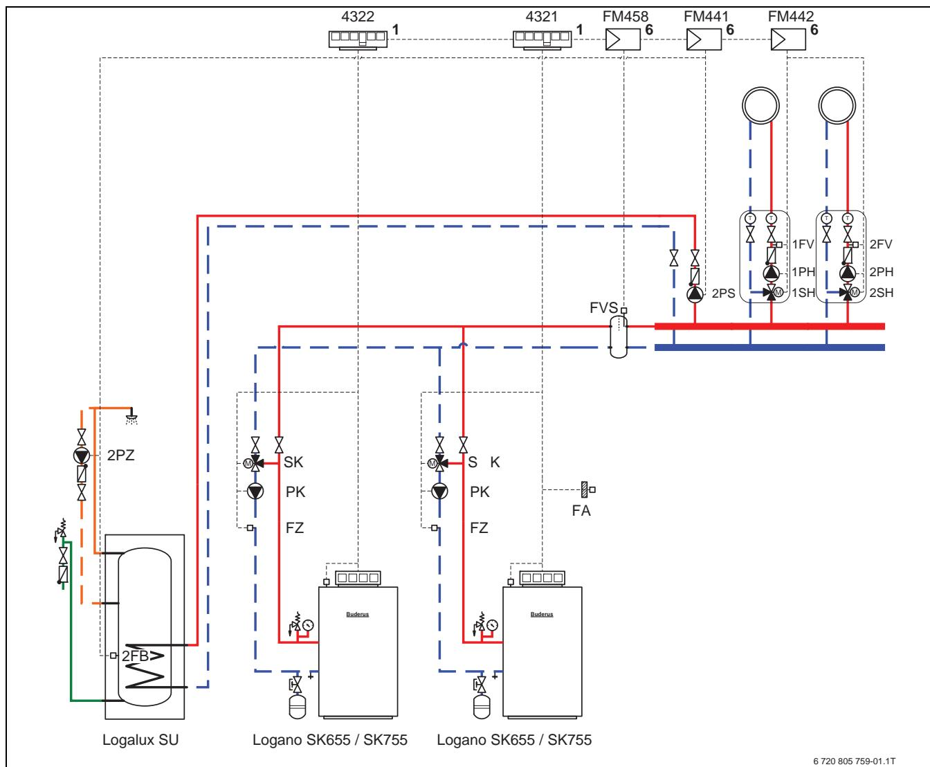
Рис. 33 Пример установки с Logano SK655 или SK755
