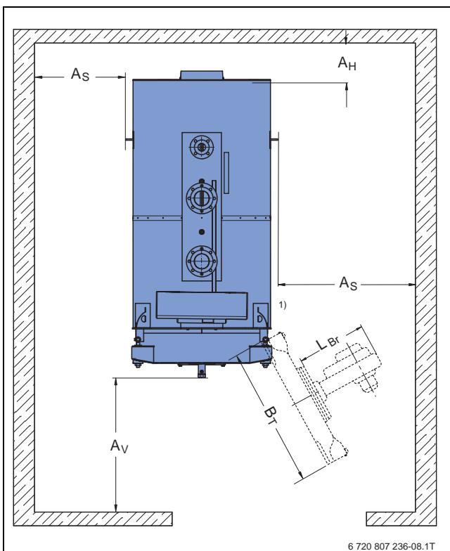
Рис. 35 Помещение с котлом Logano SK655 или SK755
