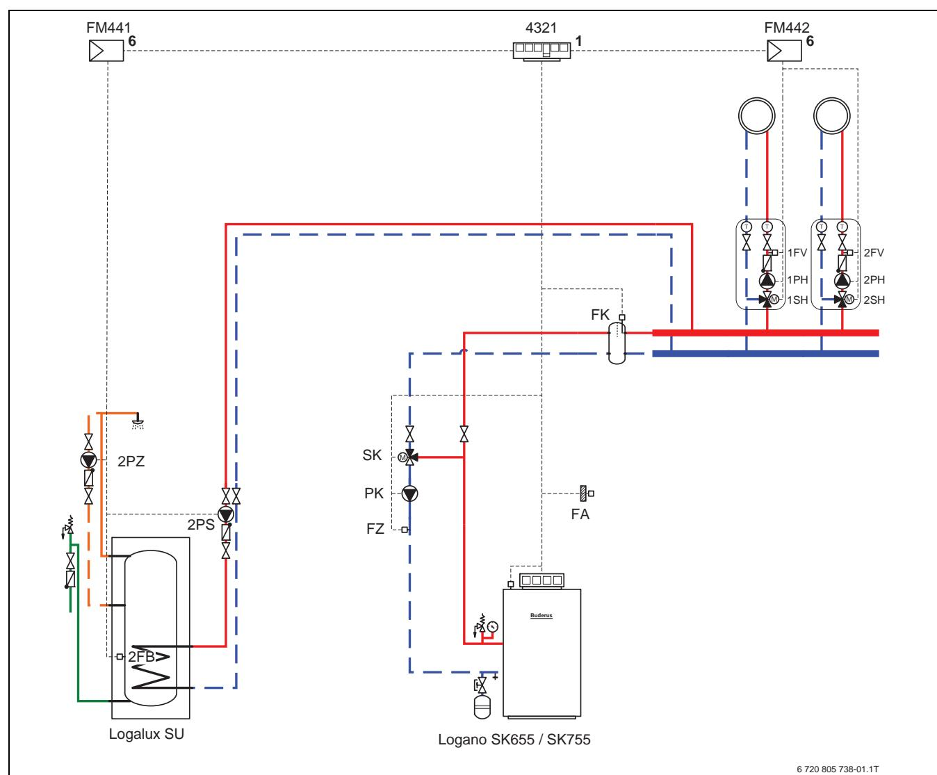
Рис. 32 Пример установки с Logano SK655 или SK755
