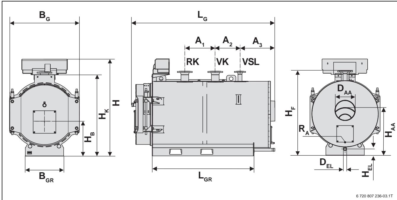
Рис. 6 Размеры Logano SK755 420 - 820 кВт
