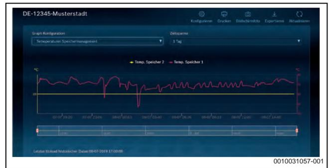
Bild 48 Control Center CommercialPLUS: Graph; Anzeige der aufgezeichneten Datenpunkte. Aktualisierung alle 6 Stunden automatisch oder manuell sofort. Max. Speicherdauer: 2 Jahre, Auflösung: 0,5°-Schritte; bis zu max. 125 Datenpunkte
