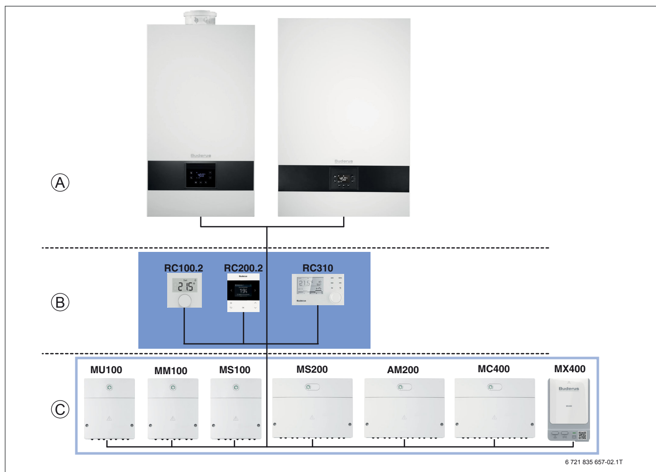
obr. 10 Přehled regulačního systému Logamatic EMS plus
