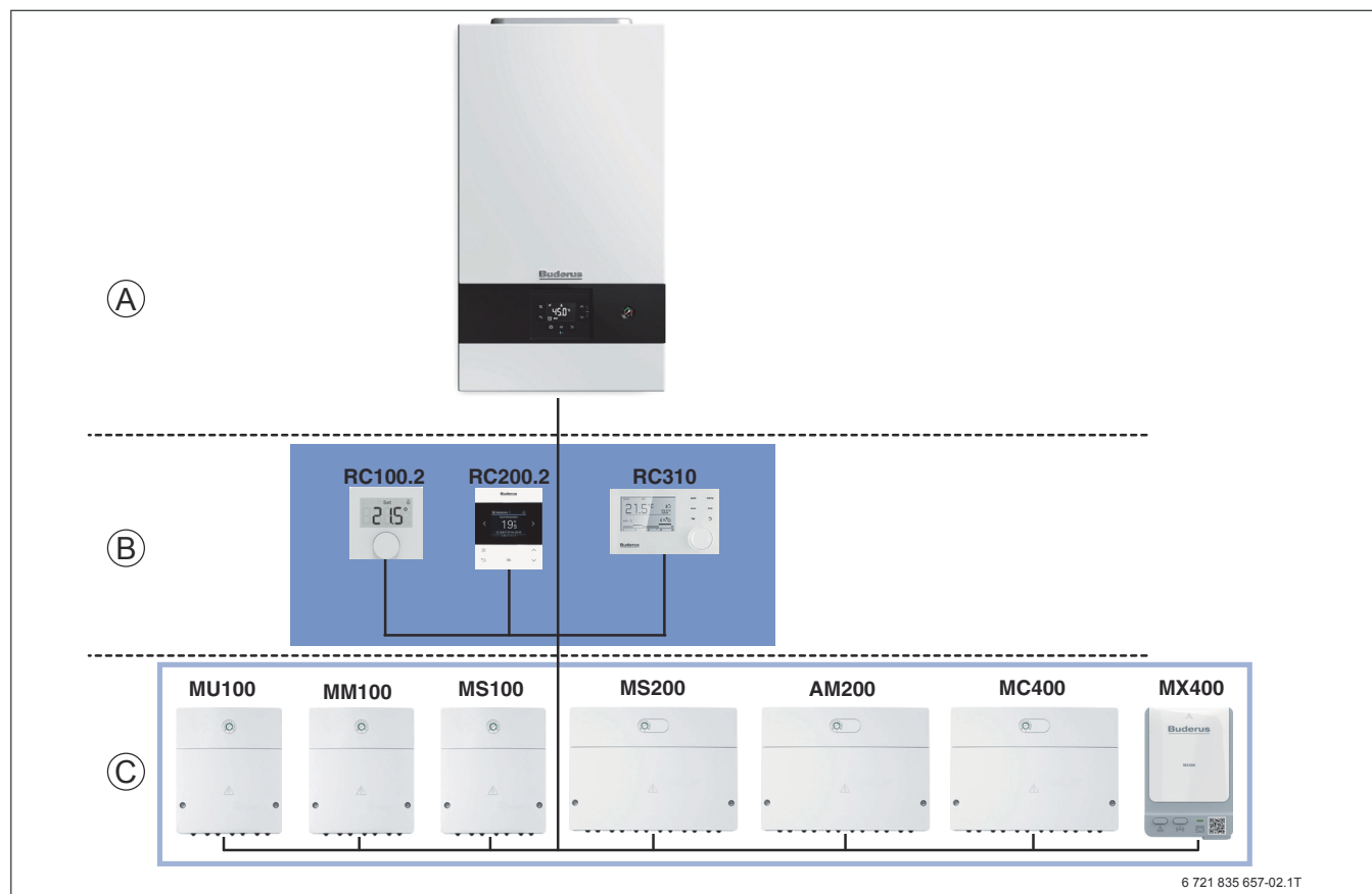
obr. 7 Přehled regulačního systému Logamatic EMS plus
