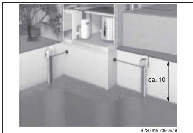
Obr. 5 Studny spodní vody (rozměry v m)
