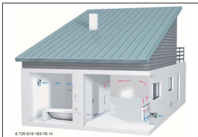
Obr. 62 Funkční schéma Logatrend Air
