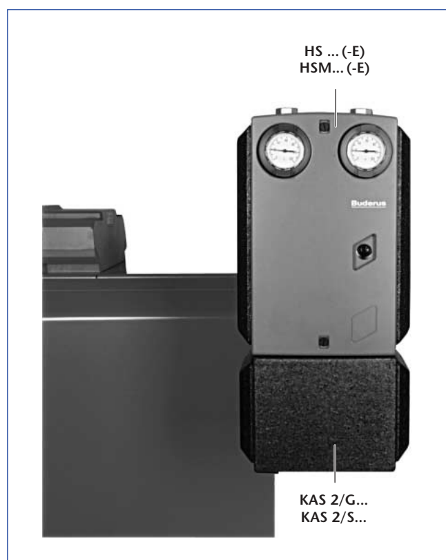
4/1 Připojení na kotel pomocí připojovací sady KAS 2/ ... paralelně vedle kotle, pro připojení jednoho, dvou nebo tří otopných okruhů pomocí sad HS...(-E) nebo HSM...(-E) na stacionární kotel Logano G....
