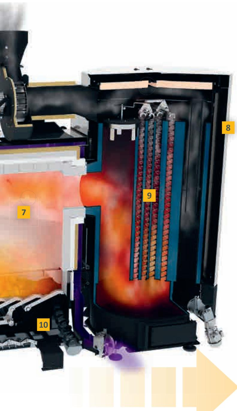
**6 Regolazione lambda e regolazione della temperatura della camera di combustione:** adattando l'adduzione di ossigeno alla qualità del combustibile, la caldaia raggiunge i massimi rendimenti con emissioni molto ridotte. La temperatura della camera di combustione regola l'unità di ricircolo del gas di scarico in funzione del fabbisogno.
