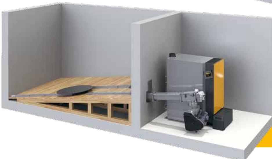
**Con o senza fondo inclinato?** Senza fondo inclinato il montaggio dell'agitatore a pavimento è più vantaggioso e si può fare affidamento su un funzionamento silenzioso. D'altra parte non sarà possibile svuotare in modo completamente automatico l'intero deposito. Al primo riempimento, questa parte viene semplicemente riempita con cippato molto secco. Se ci si decide invece per il fondo inclinato, nel deposito resterà una minore quantità di cippato.
