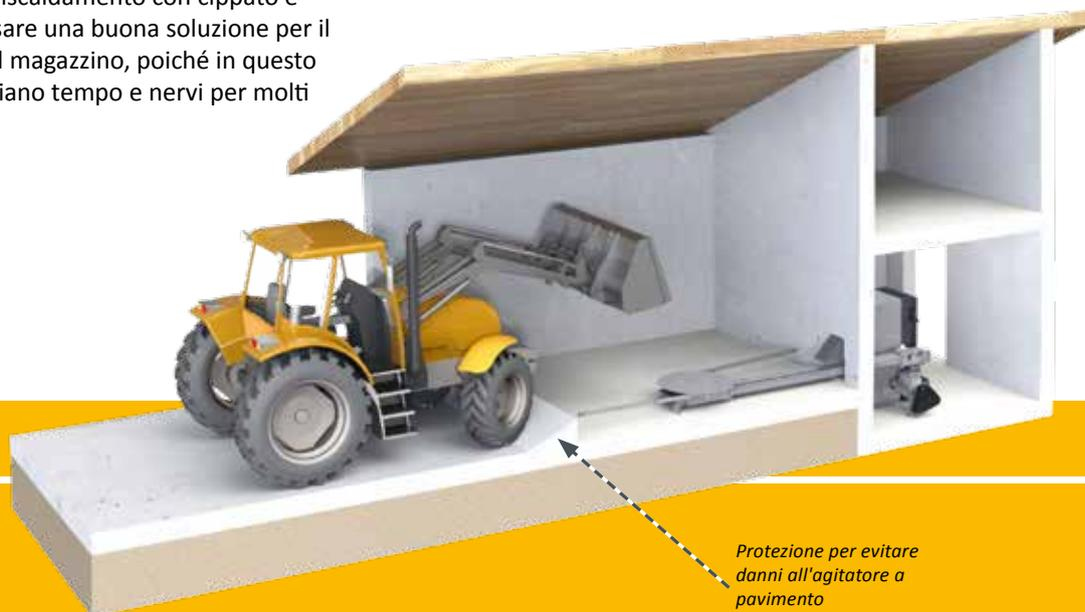
*Protezione per evitare danni all'agitatore a pavimento*
