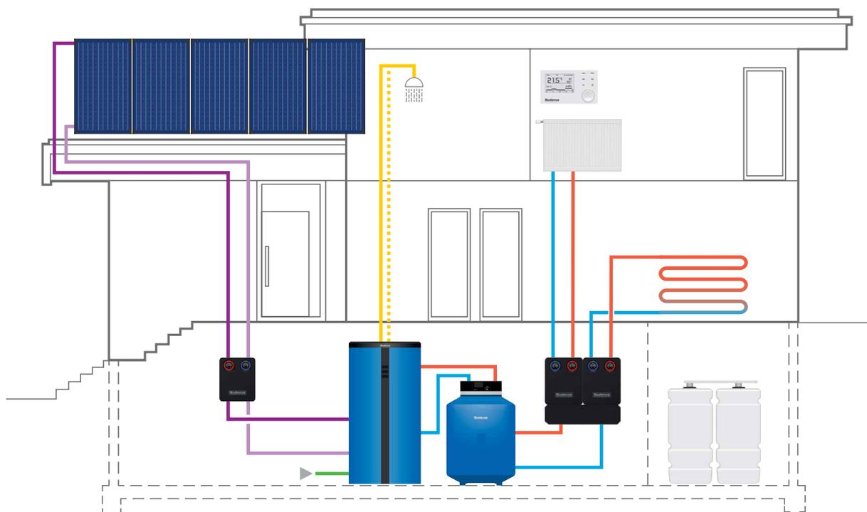
Con un sistema di riscaldamento Buderus si ottiene, elemento dopo elemento, una maggiore efficienza e un più elevato risparmio energetico, per esempio, combinando la Logano plus GB125 con un generatore di calore ad energie rinnovabili come un impianto solare. Tutti i componenti necessari al vostro comfort sono perfettamente e sinergicamente armonizzati tra loro nel sistema Buderus.
