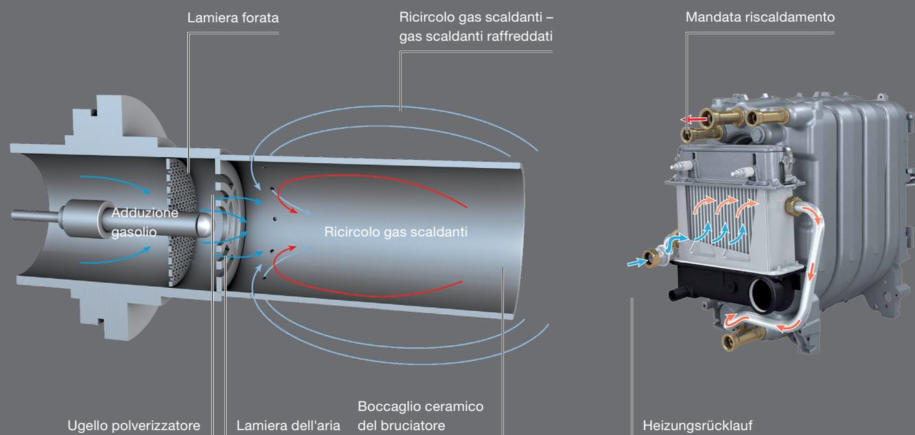
Grazie alla sua raffinata tecnologia il bruciatore a fiamma blu Logatop BE<sup>1</sup> assicura una combustione particolarmente efficiente ed esente da fuliggine. La depressione all'ugello di uscita del gasolio aspira all'indietro i gas scaldanti. In questo modo le goccioline di gasolio evaporano prima di bruciare.
