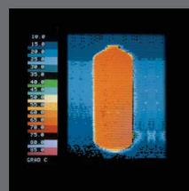
L'échangeur thermique à tubes lisses atteint le fond du ballon et chauffe uniformément tout son contenu, ce qui permet d'éviter les zones froides et d'empêcher la prolifération de germes.
