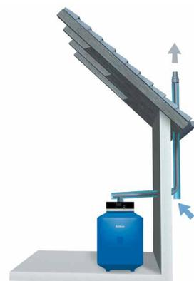
Variante type ventouse avec système d'évacuation des fumées synthétique tube dans tube le long de la façade extérieure.
