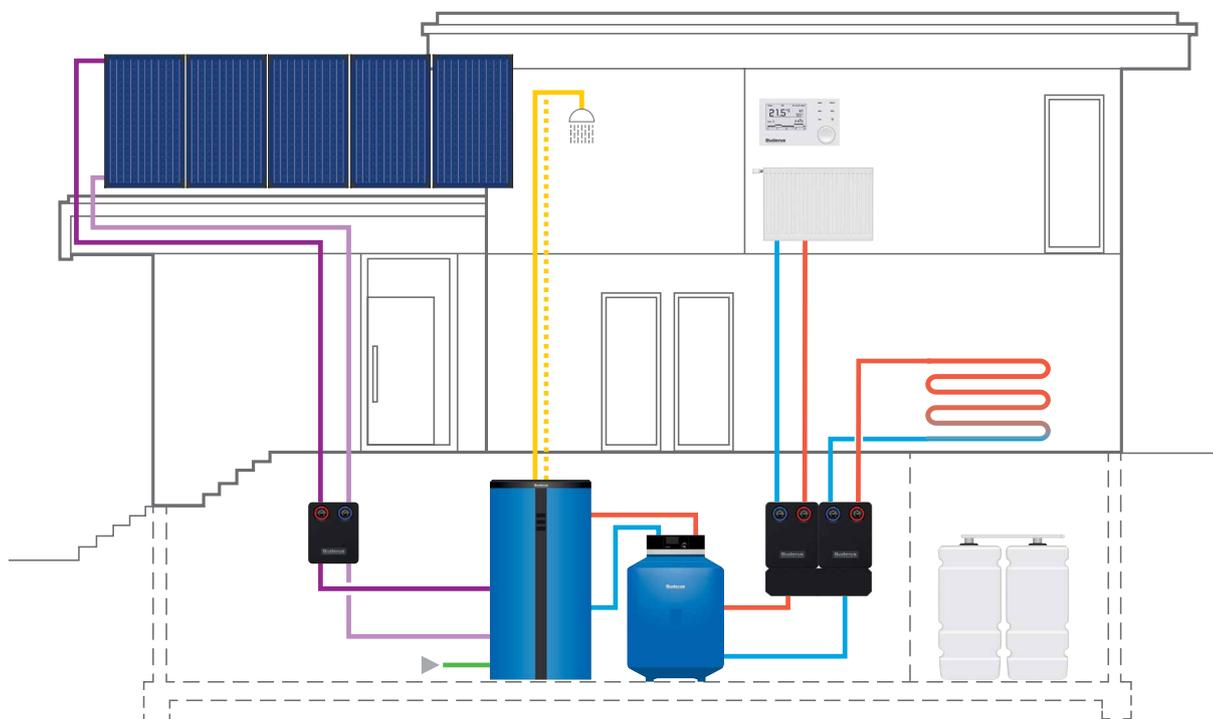
Le système de chauffage modulaire Buderus permet, pas à pas, d'augmenter l'efficacité et de réduire les coûts énergétiques. En combinant la Logano plus GB125 avec un générateur de chaleur régénératif telle qu'une installation solaire, par exemple. Dans le système Buderus, tous les composants nécessaires au confort thermique sont parfaitement et efficacement adaptés les uns aux autres.
