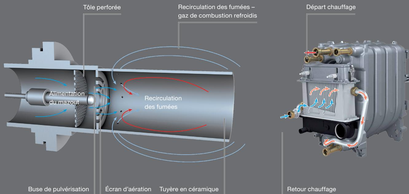
La technique élaborée du brûleur à flamme bleue Logatop BE<sup>1</sup> permet de garantir une combustion particulièrement efficace et pratiquement sans suie. La dépression située au niveau de la buse de sortie du mazout retient les gaz de combustion par effet d'aspiration. Les gouttes de mazout s'évaporent ainsi avant d'être brûlées.
